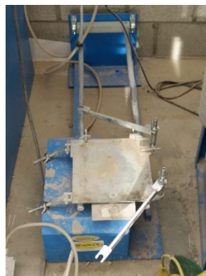
Figuur 13: Het schokapparaat voor te verdichten (foto: Jan Kerkhofs)
