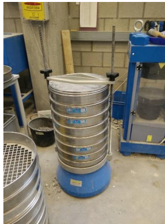
Figuur 10: De gebruikte zeeftoeren voor het uitzeven van het fijnstof (foto: Jan Kerkhofs)
