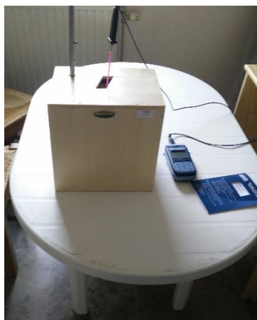
Figuur 16: De opstelling om de hydratatiwarmte te bepalen (foto: Jan Kerkhofs)
