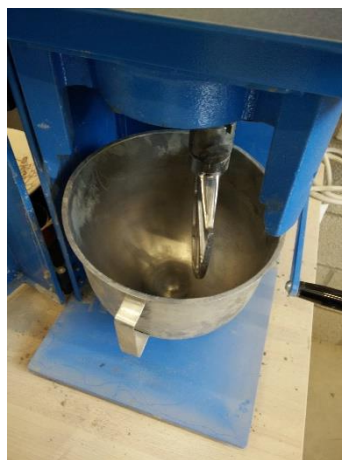
Figuur 12: De kom en de menger van de mortelmenger (foto: Jan Kerkhofs)
