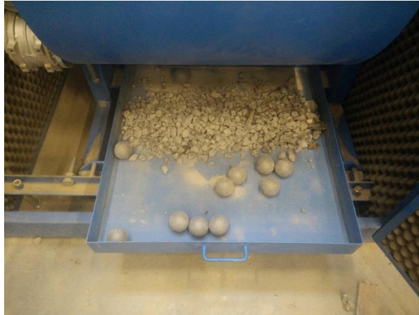
Figuur 9: De opvangschaal voor het legen van de Los Angeles trommel (foto: Jan Kerkhofs)
