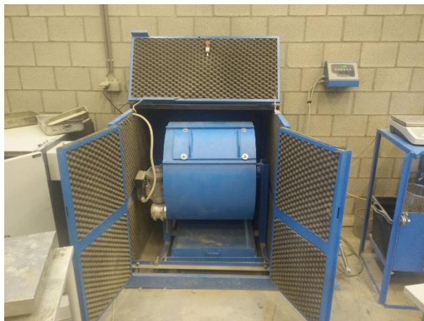
Figuur 8: De opbouw van de Los Angeles proef (foto: Jan Kerkhofs)
