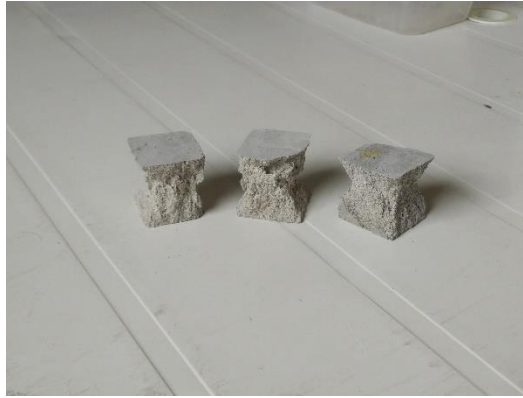
Figuur 15: het resultaat na de drukproef (foto: Jan Kerkhofs)
