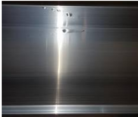
Figuur 3: Profiel met blaarvorming
