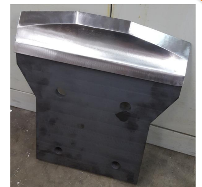
Figuur 4: Nieuw ontwerp schaarblad geproduceerd (achterzijde)
