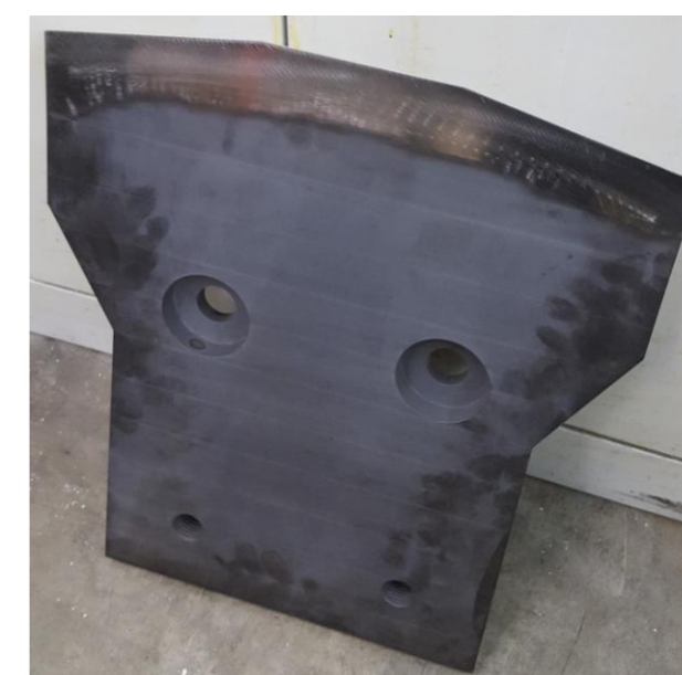
Figuur 3: Nieuw ontwerp schaarblad geproduceerd (voorzijde)
