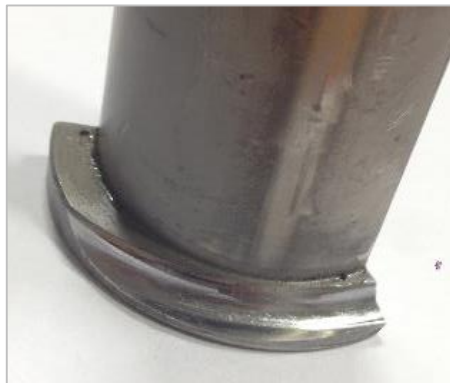
Figuur 18: Slijtage gripper
