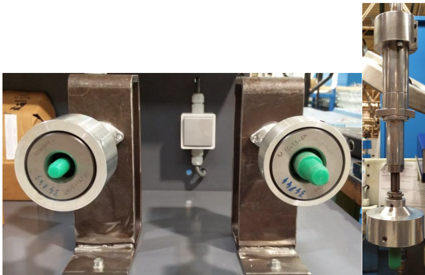
Figuur 14: Schroefdraadkaliber bevestigd aan de PLUTO 10CA-FN
