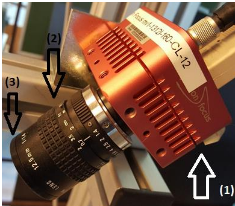
Figuur 3-12: Cameraconfiguratie met (1) Photonfocus-camera, (2) lens en (3) bandpassfilter
