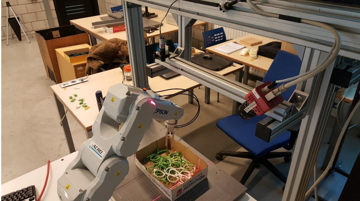
Figuur 3-11: Bin picking-opstelling met pikrobot en lineaire geleiding met camera en laser
