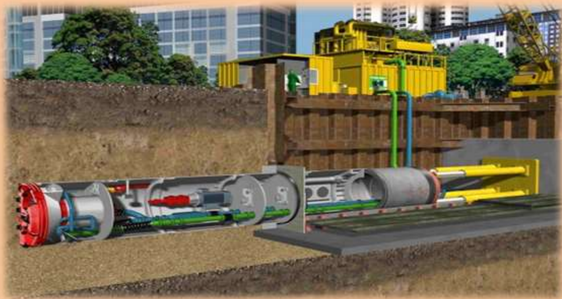
Figuur 3: Booropstelling microtunneling met hydraulisch grondtransport [4]
