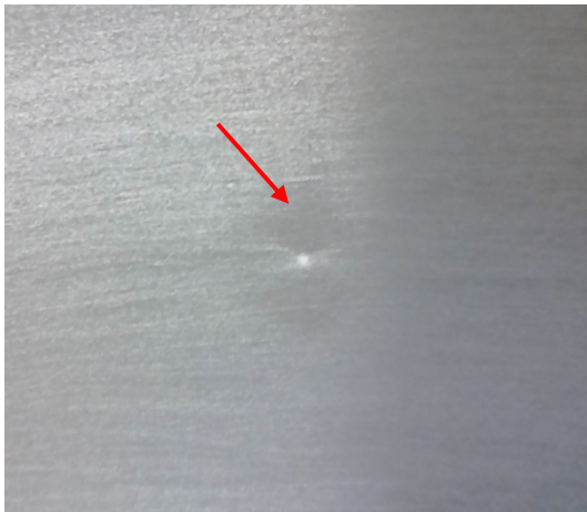
Afbeelding 37a: Puimpad contrasttest (ernstegraad 2-3)
