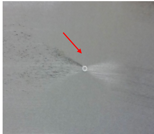
Afbeelding 36b: Puimsteen contrasttest (ernstegraad 2-3)
