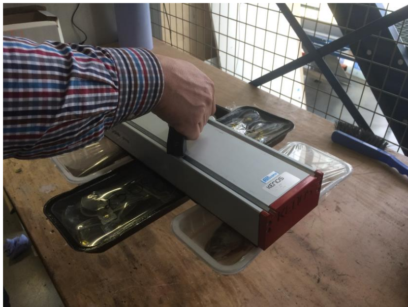
Figuur 39: Test van een vacuüm mat met verpakte visschaaltjes
