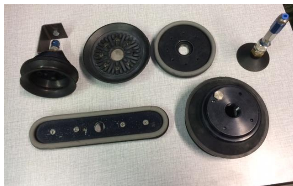
Figuur 36: Zuignappen testopstelling
