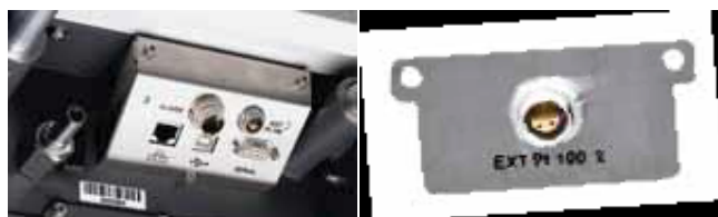
Figuur 34: Het aansluitpaneel van Presto A85 (Julabo, PRESTO A85 temperature control system, 2017)
