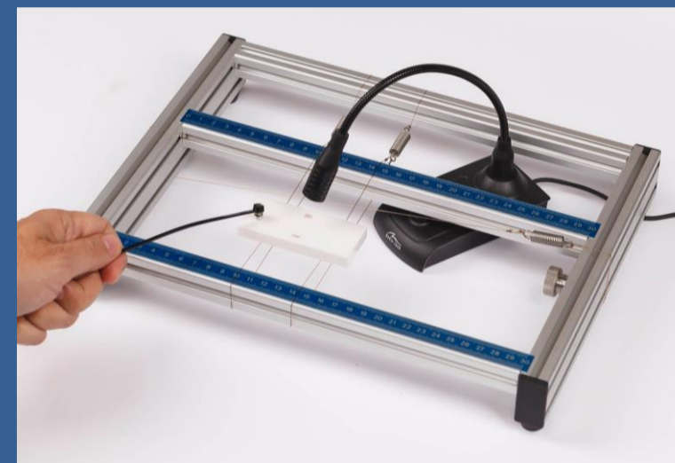
Figuur 1: Impulsexcitatiesysteem: RFDA basic (IMCE.nv, 2017)
