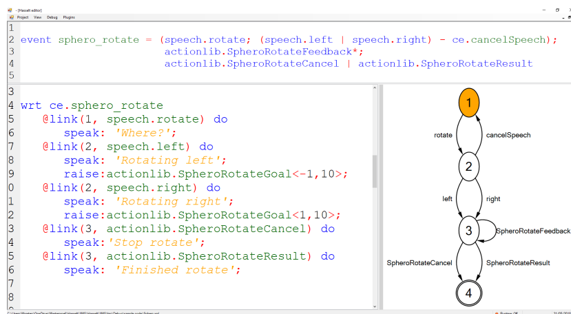
Figuur 6.6: De SRDL code en FSM voor de SpheroRotate actie. In deze action client wordt een feedback loop geïmplementeerd.
