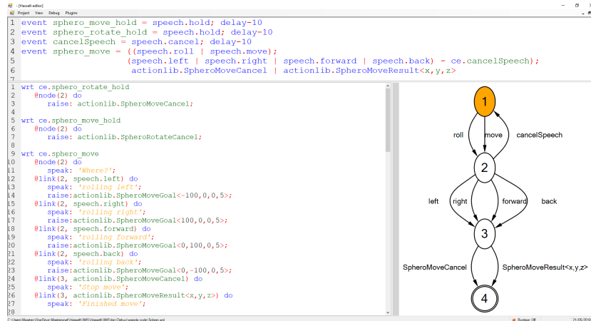
Figuur 6.5: De SRDL code en FSM voor de SpheroMove actie. Zoals wordt weergegeven, zal afhankelijk van de uitgesproken richting, het SpheroMoveGoal event worden opgeroepen met een bepaalde richting. Op het moment wordt de afstand die Sphero aflegt meegegeven aan het SpheroMove event. Dit zou tevens kunnen worden opgenomen in de standaard waarden van het doel. Het is echter handig bij het testen om deze eenvoudig in SRDL editor aan te kunnen passen.
