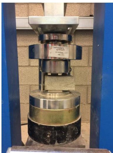
Figuur 15: Proefopstelling drukproef mortel/lijmmortel
