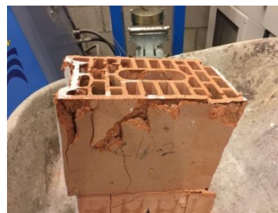
Figuur 47: Scheurpatroon enkele kleisteen
