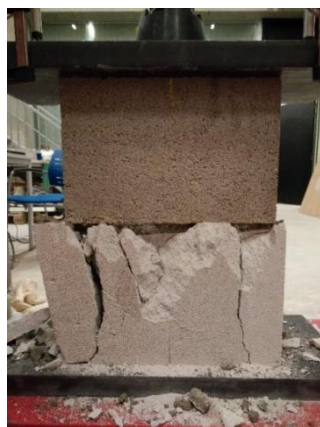
Figuur 54: Scheurpatroon hybride combinatie cellenbeton met betonsteen met mortelvoeg
