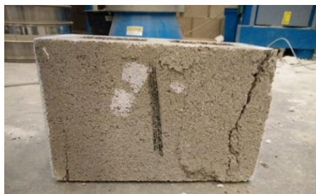
Figuur 52: Scheurpatroon enkele betonsteen
