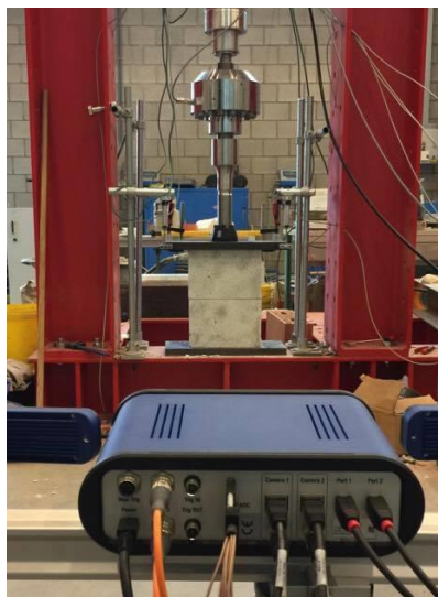
Figuur 18: Proefopstelling gestapelde stenen met LVDT's en DIC
