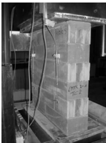
Figuur 9: Test opbouw, druksterkte van metselwerkmuur gemaakt met deels halve stenen
