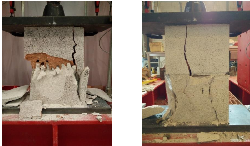
Figuur 49: Scheurpatroon composiet combinatie cellenbeton en klei (Links: lijm en rechts: mortel)
