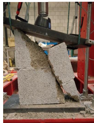
Figuur 53: Scheurpatroon homogene combinatie betonsteen met mortelvoeg
