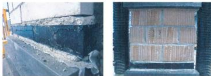
Figuur 13: Proefopstelling drukproef op composiet muur met cellenglas en kleisteen [17]
