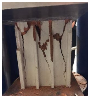
Figuur 47: Scheurpatroon enkele kleisteen
