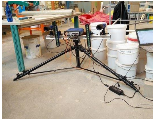
Figuur 17: Proefopstelling met DIC
