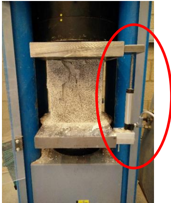
Figuur 16: Proefopstelling enkele stenen met LVDT's
