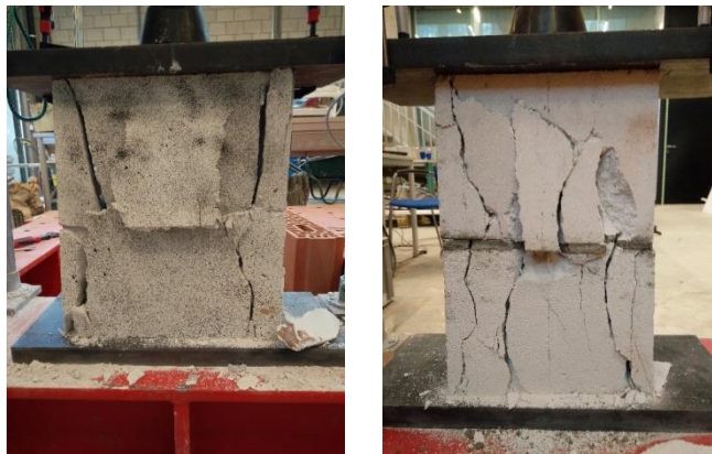
Figuur 43: Scheurpatroon na drukproef dubbel cellenbetonstenen ( links: lijmmortel en rechts: mortel)
