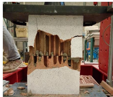
Figuur 48: Scheurpatroon gestapelde kleisteen (links: lijm en rechts: mortel)
