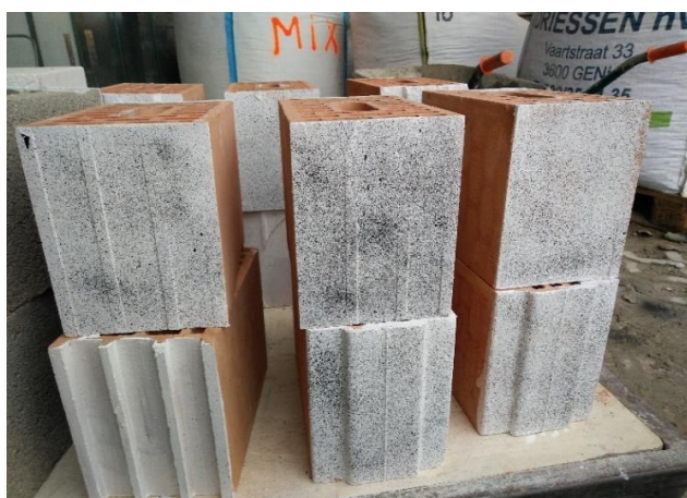
Figuur 23: Voorbereiding stenen voor metingen DIC
