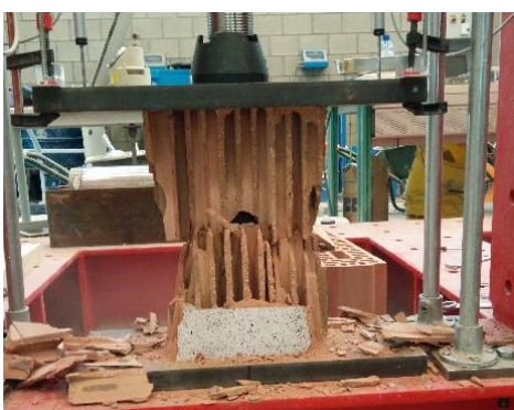
Figuur 48: Scheurpatroon gestapelde kleisteen (links: lijm en rechts: mortel)
