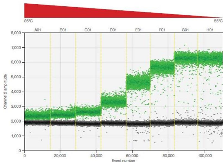
Figuur 30: Optimalisatie clusterscheiding door gebruik van een temperatuurgradiënt voor de annealingtemperatuur: door een verlaging van de annealingtemperatuur kan de opbrengst aan PCR-product groter worden (Ch2 Amplitude stijgt) [7]
