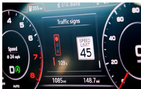
Figuur 4: Numerieke countdown timer in het voertuig geplaatst [19]
