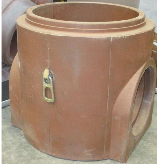
Figuur 13: Basis putelement uit zwavelbeton [25]
