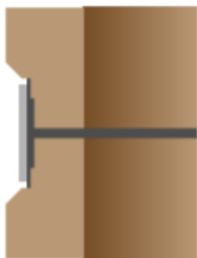
Figuur 15: Dichting putonderdeel/ opzetstuk voor DN1200 tot DN1400 [11, p. 14]
