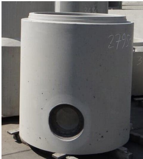
Figuur 2: Ronde betonnen inspectieput [25]
