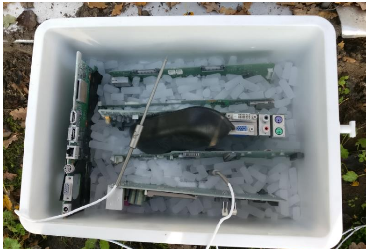
Figuur 32: Proefopstelling uitlokken tinpest in koelbox
