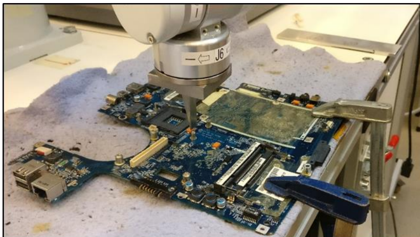
Figuur 40: Opstelling manueel afschrapen met robot
