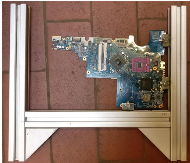
Figuur 44: Printplaatklem voor testopstelling bij selectief afschrapen met computervisie
