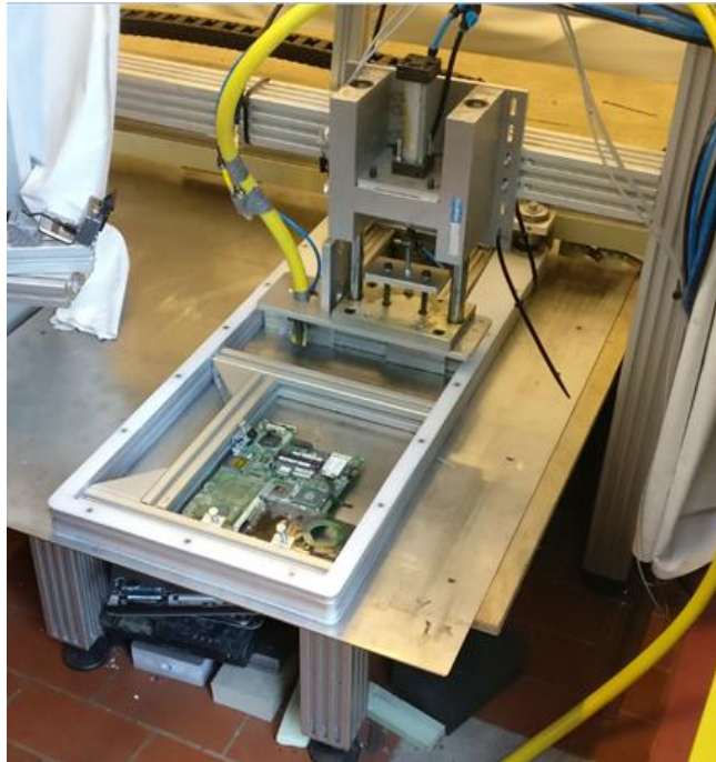
Figuur 43: Bovenaanzicht testopstelling selectief afschrapen met behulp van visiesysteem
