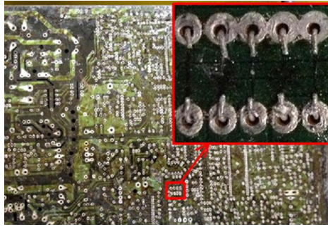
Figuur 16: Omgebogen pinnen bij 'through hole devices' [7]
