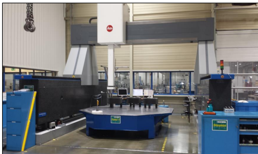
Figuur 6: Automatische 3D coördinaatmeetmachine in een meetafdeling van ZF
