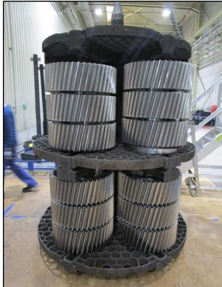
Figuur 60: Totale opbouw van de tweede testbatch voor het hardingsproces
