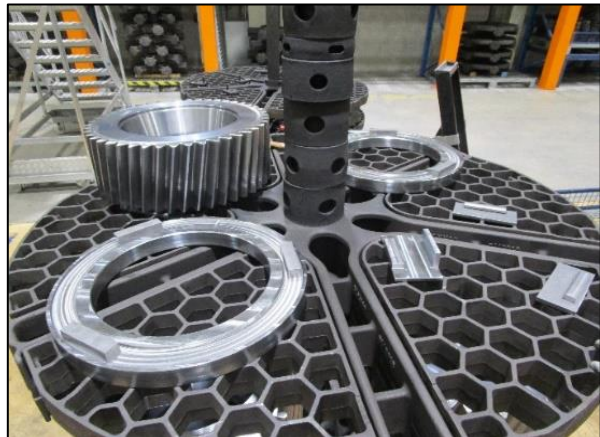
Figuur 58: Twee dummy ringen en kantelende ondersteuning gepositioneerd op de spin
