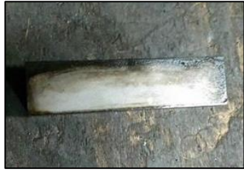
Figuur 76: Ondersteuningsblokje dat tussen de componenten wordt geplaatst
