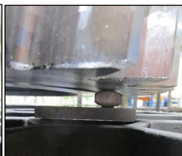
Figuur 43: Kantelende ondersteuning in 'rust'-positie
