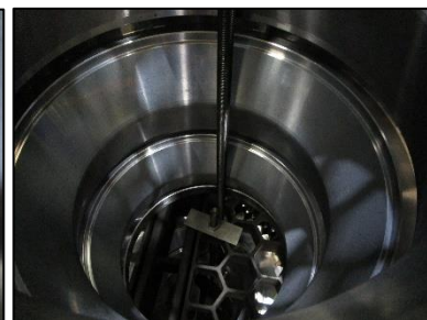
Figuur 74: Draadstang tussen spin en voet
