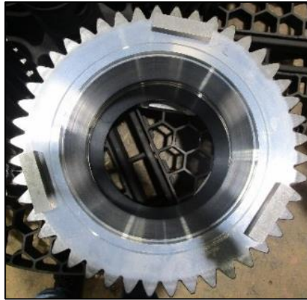
Figuur 59: Ondersteunings- blokjes tussen de verschillende componenten
