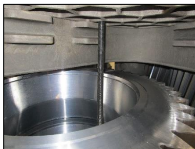
Figuur 72: Draadstang 1 tussen de voet en de spin
