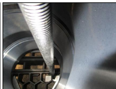
Figuur 73: Draadstang tussen voet en spin, speling t.o.v. de conen
