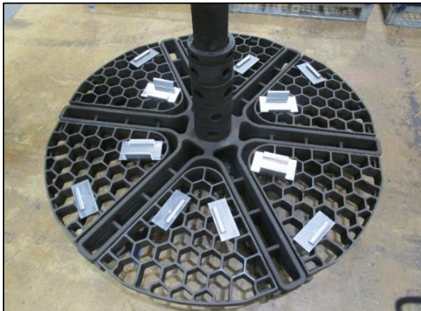
Figuur 57: Kantelende ondersteuningstype, viermaal gepositioneerd op de voet
