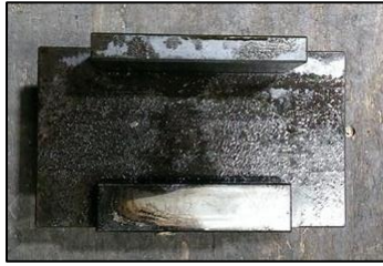
Figuur 75: Het 'vast' gedeelte van de kantelende ondersteuning
