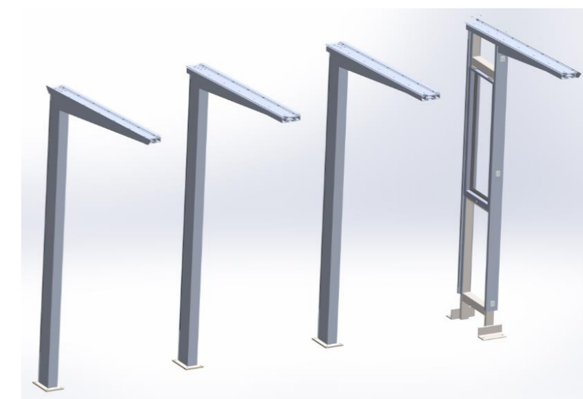
Figuur 4: Galgconstructie abri
