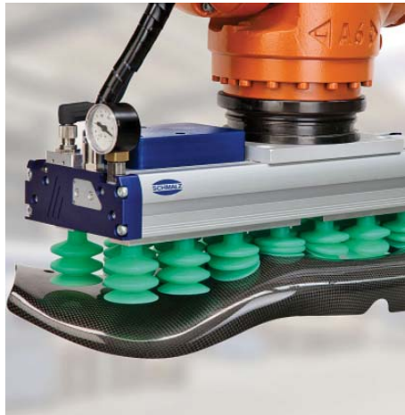
Figuur 3.9: Aanpasbaarheid van zuignappen die niet toereikend is [1]
