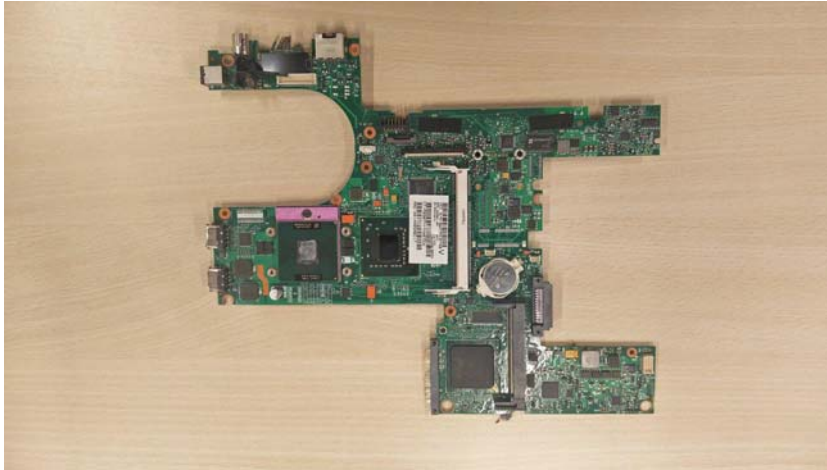
Figuur 3.4: Printplaat met uitsparingen aan de zijkant
