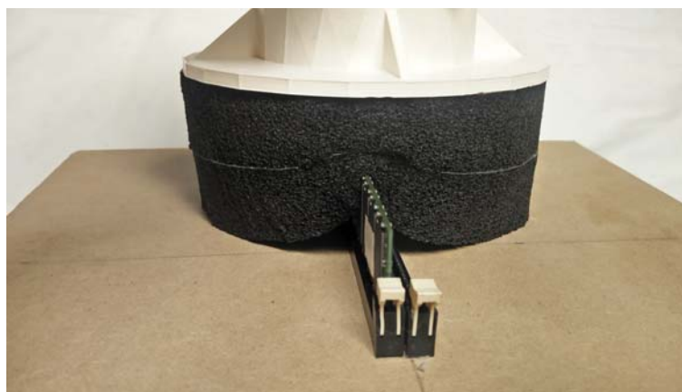
Figuur 4.34: Aanpassingsvermogen aan RAM-slots van dichting 1D
