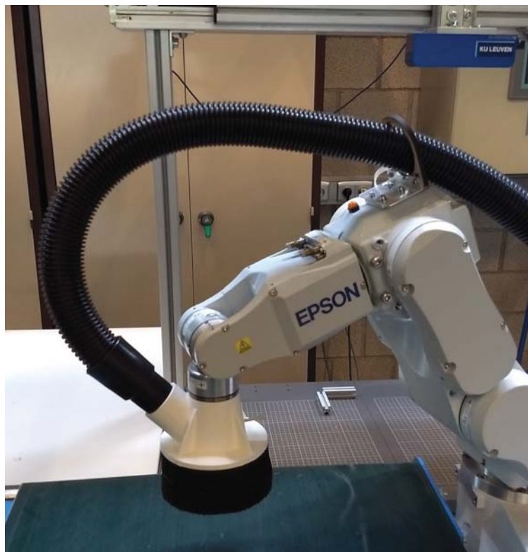
Figuur 4.58: Buigstraal van de slang op robot
