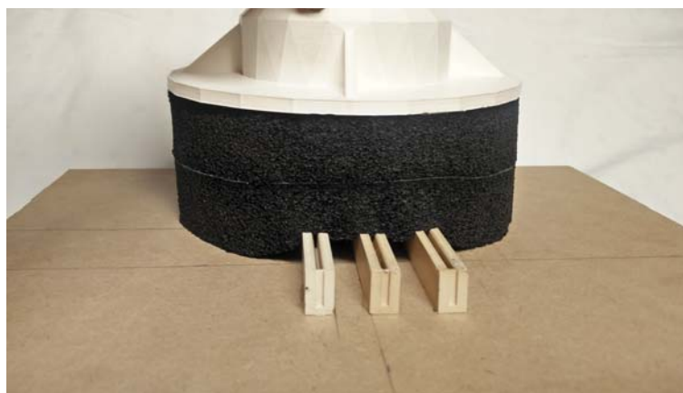
Figuur 4.27: Aanpassingsvermogen aan PCI-slots van dichting 1D
