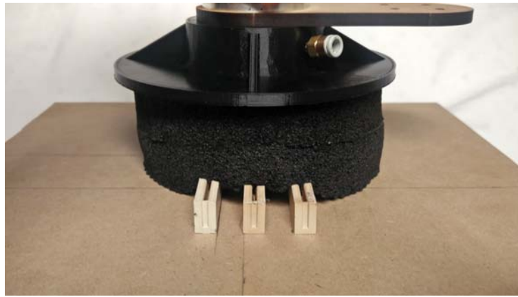
Figuur 4.26: Aanpassingsvermogen aan PCI-slots van dichting 1C
