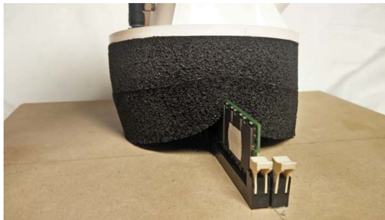
Figuur 4.35: Aanpassingsvermogen aan RAM-slots van dichting 3A en 3B
