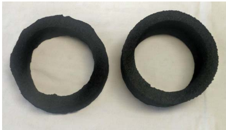
Figuur 4.51: Fabricagekwaliteit dichtingen 1A (links) en 1B (rechts)
