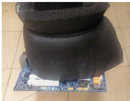
Figuur 3.14: Conceptuele flow gripper die een printplaat grijpt
