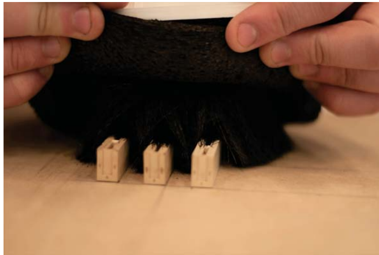
Figuur 4.29: Aanpassingsvermogen aan PCI-slots van dichting 3A en 3B
