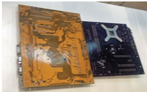
Figuur 6.3: Werkelijke stapeling printplaten waarvan de randen goed op elkaar aansluiten
