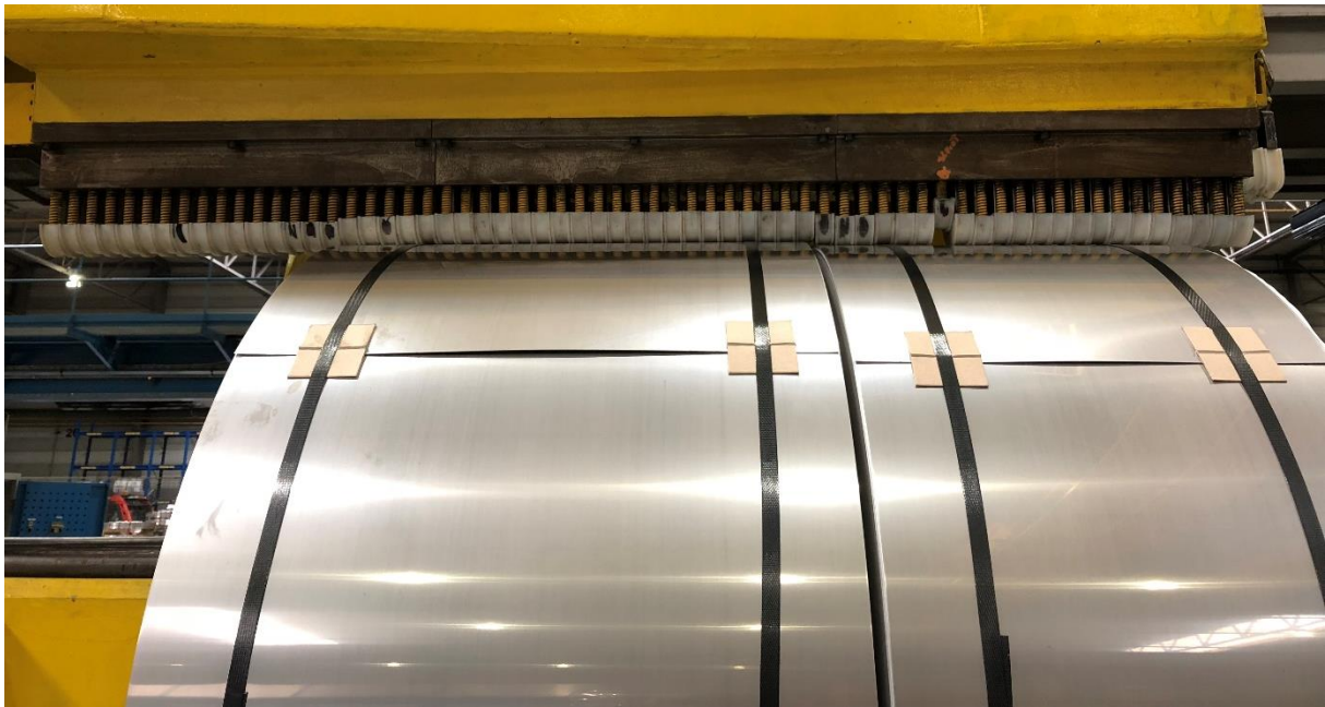
Figuur 18: Strapband met kartonnen plaatje over braam op het einde van de coil
