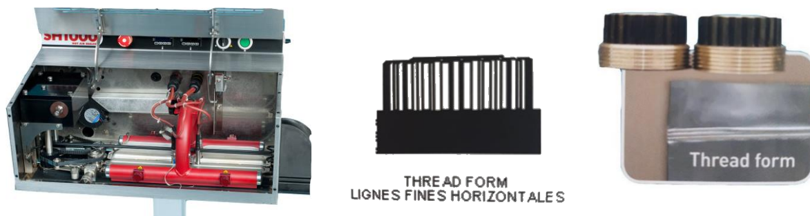
Figuur 47: a) Hot air sealer met draadvormig profiel, b) Draadvormig profiel, c) Draadvormig profiel
