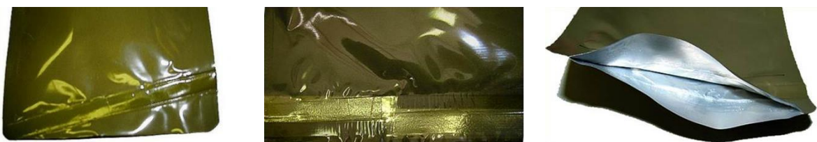
Figuur 28: a) Seal niet parallel aan wand, b) Slecht uitgelijnde seal, c) Slecht hechtende seal [63]
