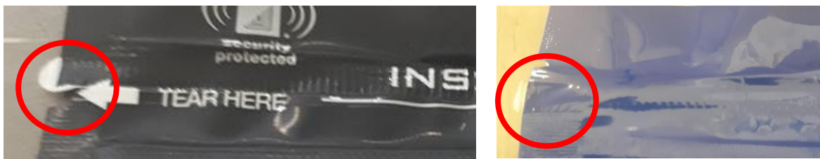
Figuur 87: Delaminatie bij te hoge sealtemperaturen a) film 2, b) film 1
