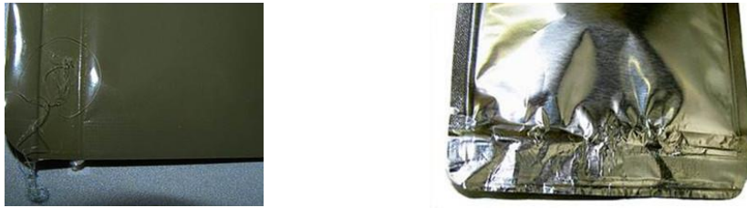
Figuur 29: a) Dradige seal, b) Plooiën/kreuken in seal [63]
