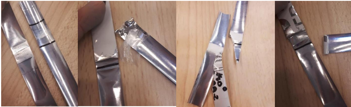
Figuur 78: a) Peel, b) Tear + delaminatie, c) Laterale insnijding, d) Tear
