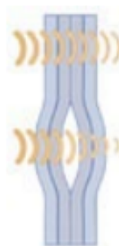
Figuur 35: Ultrasonische golven doorheen meerlaags materiaal; bovenaan zonder defect, onderaan met lek [74]
