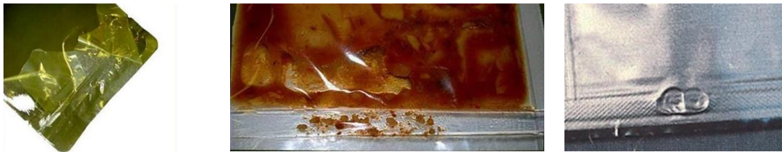
Figuur 27: a) Delaminatie ter hoogte van verpakkingsseal, b) Gecontamineerde seal, c) Indrukking in seal [64]
