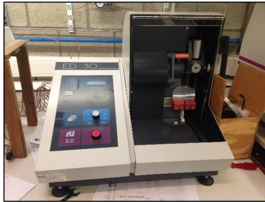
Figuur 16: MTS Adamel Lhomargie ED 30 machine voor het meten van de doorscheurweerstand
