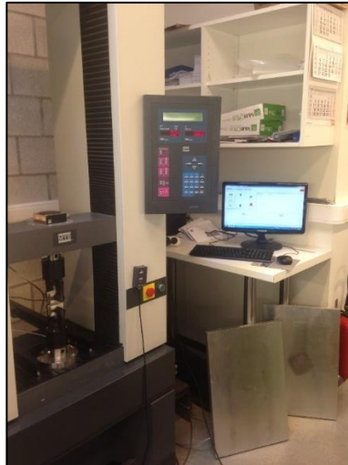
Figuur 14: Trekbank MTS 10/M waarmee de testen worden uitgevoerd
