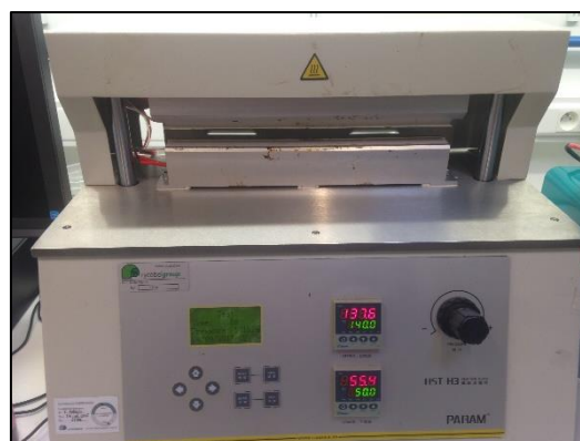
Figuur 1: Labthink HST-H3, labtoestel om te sealen met warme lasbalken
