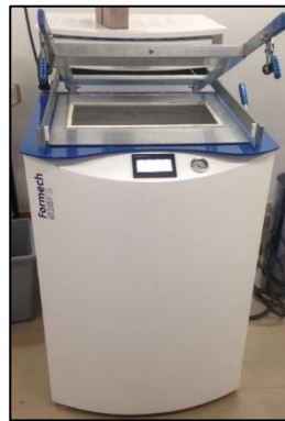
Figuur 47: Formech 508FS thermovormtoestel
