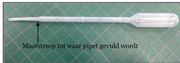
Figuur 33: Pasteurpipet van 3\text{ ml} voor het aanbrengen van vloeibare vervuilingen
