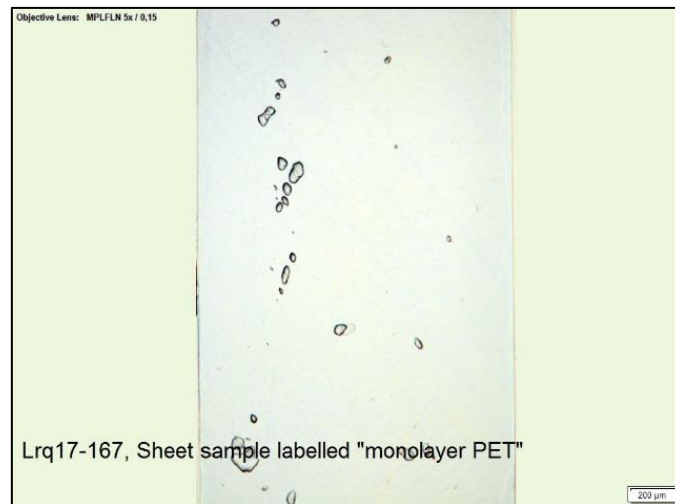
Figuur 51: Microscopische foto laagstructuur traymateriaal
