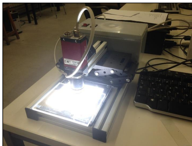
Figuur 36: Cameraopstelling labo KU Leuven
