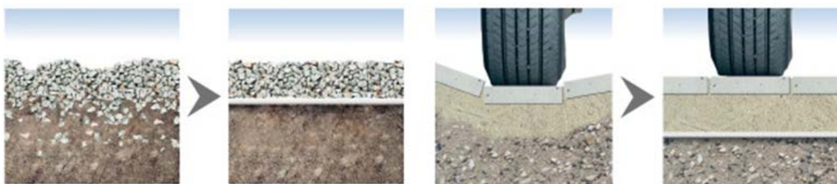
Figuur 20: Scheiding van lagen (links) en verhoging van het draagvermogen (rechts) [23]
