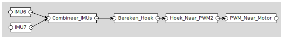
Figuur 48 Stroomdiagram van de IMU's die gestuurd worden naar de motor
