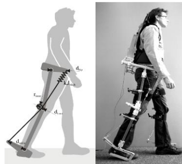
Figuur 75 Passief exoskelet [2]
