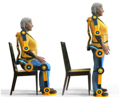
Figuur 74 Actief exoskelet [1]
