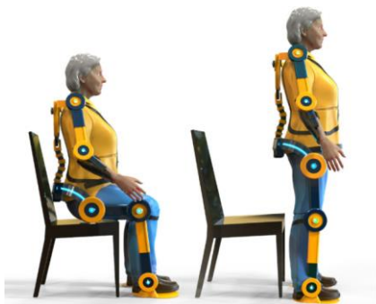
Figuur 2 Actief exoskelet [9]
