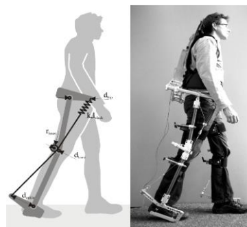
Figuur 3 Passief exoskelet [18]
