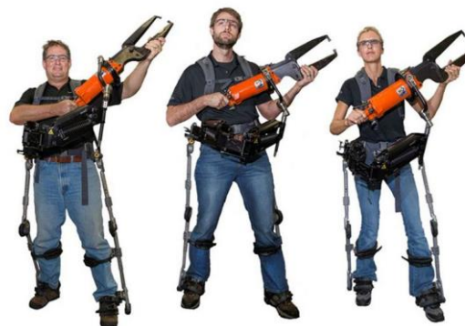
Figuur 5 Industrieel exoskelet [23]
