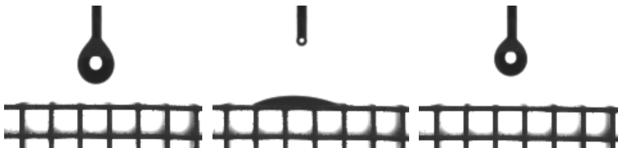
Figuur 3.1: Contacthoekmeting van een 4 m% PVDF-acetondruppel op een vlak cordierietsample vlak voor het vallen van druppel (links), net na het vallen van druppel (midden) en na volledige absorptie van druppel (rechts)
