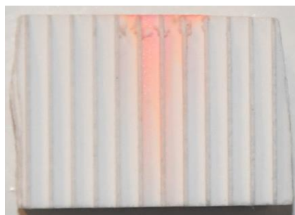
Figuur 3.5: Doorsnede van sample gespraycoat met AccuMist nozzle en parameters Q = 0,20 ml/min, x = 5 mm en t = 40 s
