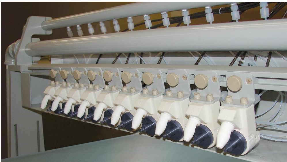
Figuur 4.6: Set-up van verschillende Impact nozzles naast elkaar om grotere oppervlaktes te spraycoaten [64]
