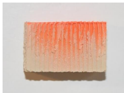
Figuur 4.2: Doorsnede van een sample met een CPSI van 900 en een hoogte van 10 mm dat gespraycoat is met de optimaal gevonden parameters
