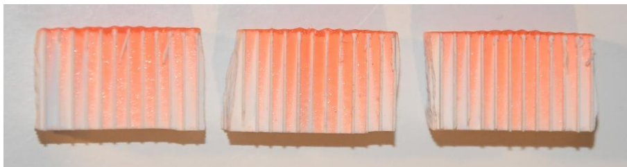
Figuur 3.38: Samples gespraycoat met Impact nozzle met gebruik van gasstroom en luchtzuigsysteem met parameters Q = 0,65 ml/min, x = 45 mm en p = 20 kPa (links), 30 kPa (midden) of 40 kPa (rechts)
