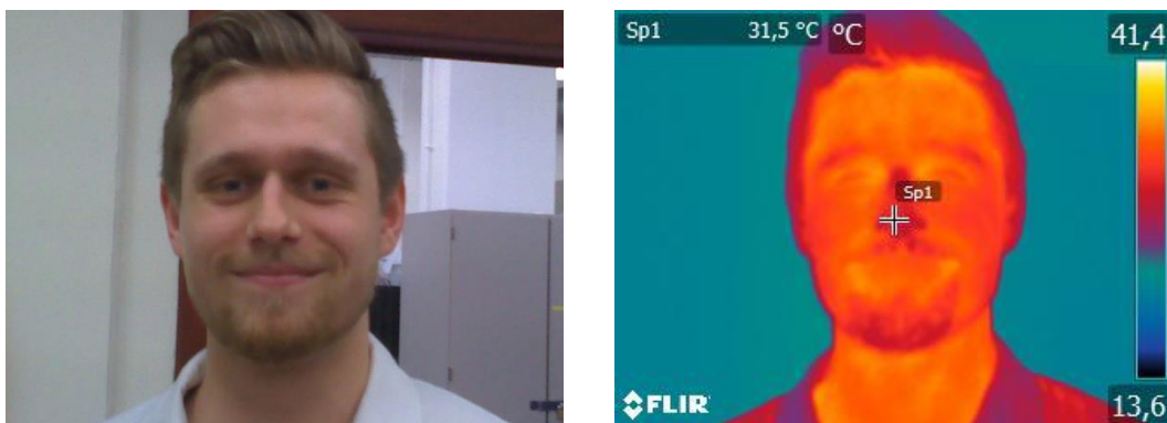
Figuur 2.22: Vergelijking van een beeldopname met een gewone camera (links) en een warmtebeeldcamera (rechts)
