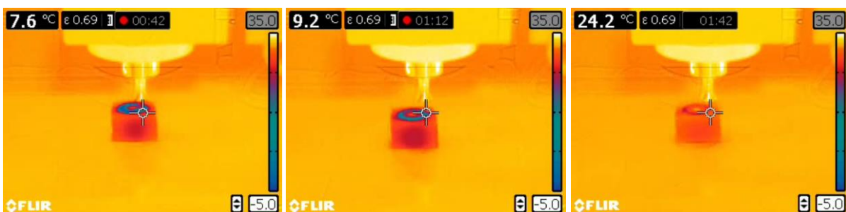
Figuur 3.52: Warmtecamerabeelden bij het gebruik van de orbital shaker en het luchtzuigsysteem na 30 s sprayen (links), na 60 s sprayen (midden) en 30 s na afloop van het sprayprogramma (rechts)
