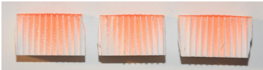
Figuur 3.36: Samples gespraycoat met Impact nozzle met gebruik van gasstroom met parameters Q = 0,60 ml/min, x = 40 mm en p = 20 kPa (links), 30 kPa (midden) of 40 kPa (rechts)
