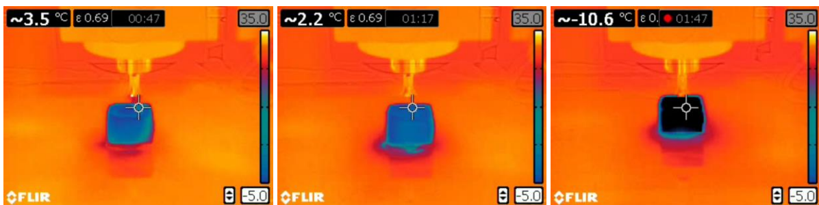
Figuur 3.51: Warmtecamerabeelden bij het gebruik van de orbital shaker na 30 s sprayen (links), na 60 s sprayen (midden) en 30 s na afloop van het sprayprogramma (rechts) 18
