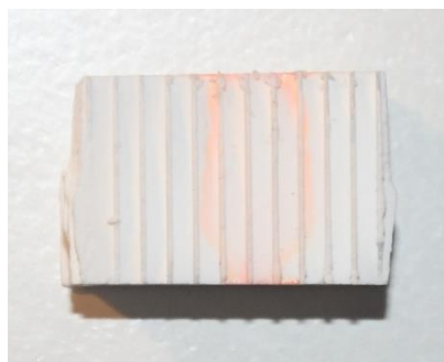
Figuur 3.17: Doorsnede van staal gespraycoat met optimale parameters bij gebruik van Impact nozzle zonder gasstroom
