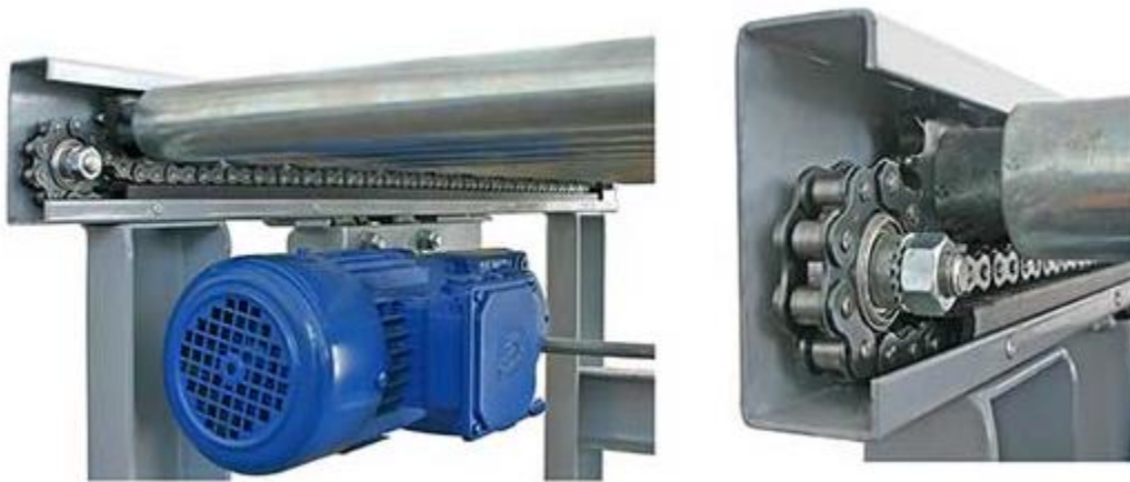
Figuur 2-9: Aandrijving rollenbaan met ketting [10]
