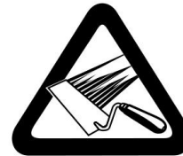
Fig. 5: aan de vezelvlieskant van het membraan bevindt zich het bovenstaande pictogram. Dit geeft aan dat deze kant ingesmeerd kan worden met mortel.
