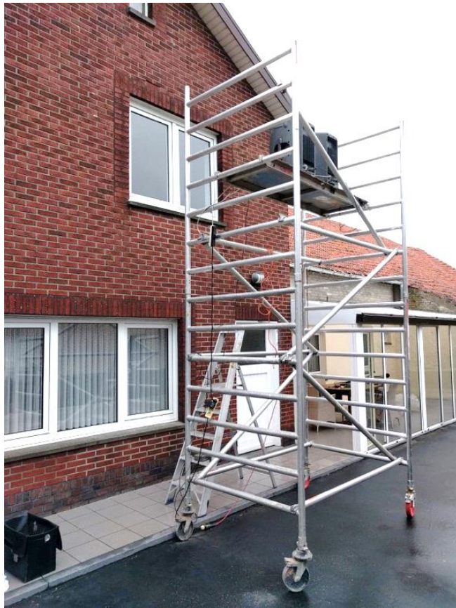
Figuur 51: Stelling met twee geluidsbronnen (roze ruis)
