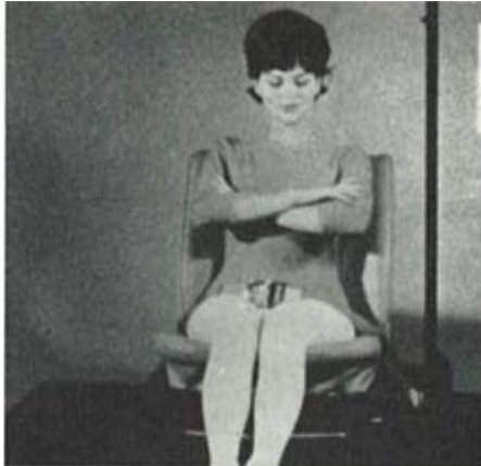
FIGUUR 2 Demonstratie van single diagonal belt tijdens het dynamisch testen (40 km/h), 25 ms na impact (Aldman, 1962)
