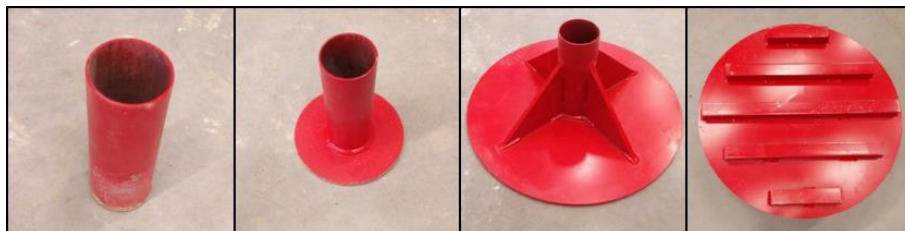
Figuur 15: De verdichtingsplaten (van links naar rechts) voor de kleine mal, de middelmatige mal en twee varianten voor de grote mal
