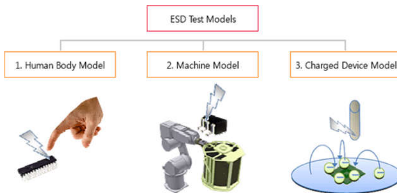
Figuur 40 De verschillende testmodellen voor ESD [37]
