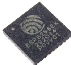
Figuur 2: ESP8266 SoC [8]
