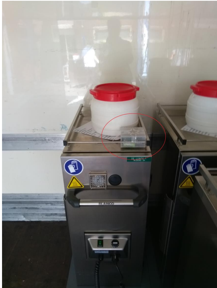
Figuur 61: Voedselcontainer met IEFT-toestel
