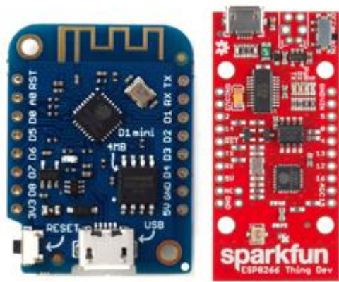
Figuur 19: Wemos D1 mini & Sparkfun ESP8266 Thing dev [21] [22]
