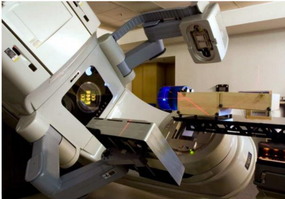
Figuur 29: Opstelling OBI beeldverwerking met Catphan fantoom
