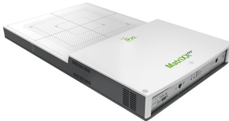
Figuur 16: MatrixX dat gebruikt zal worden tijdens de dosimetrische metingen. Tegenover de waterbak zal deze een grovere weergave creëren van de dosisprofielen. [28]
