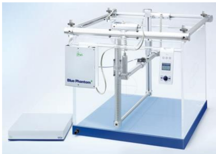
Figuur 18: Weergave van het waterfantom (Blue Water phantom 2) dat gebruikt wordt tijdens de jaarlijkse dosimetrische metingen met de LINAC's. [31]
