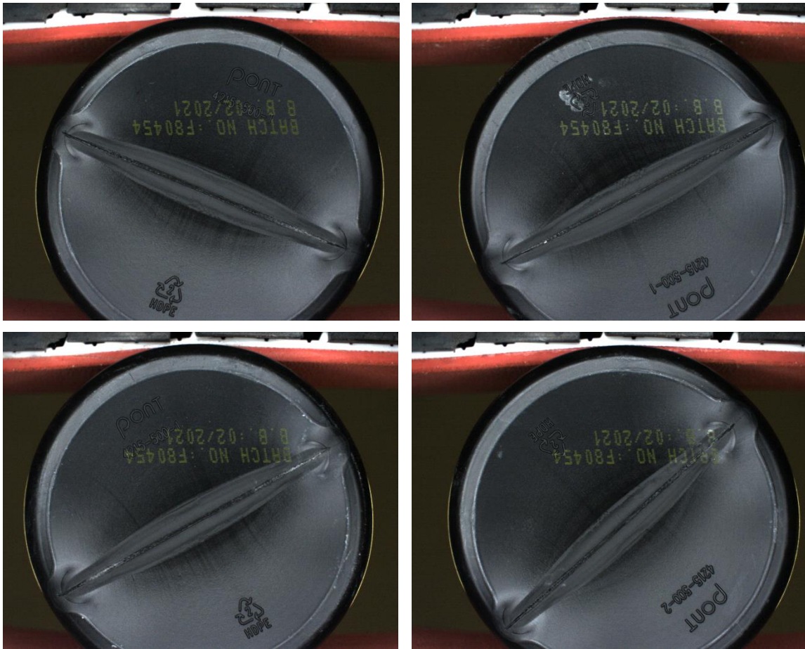
Figuur 67: Foto's van goed gelezen verpakkingen (zwart met gele codering) gemaakt door de In-Sight 7600
