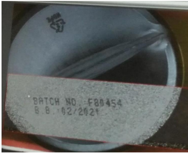
Figuur 59: Beeld na toepassen Hue-filter maar zonder ruis filters
