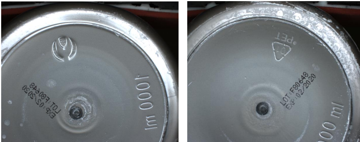
Figuur 72: Foto's van goed gelezen verpakkingen met stof (grijze met zwarte codering) gemaakt door de In-Sight 7600
