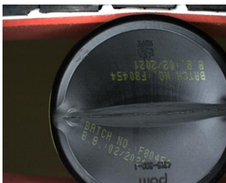
Figuur 61: Afbeelding met aan de boven zijde een bedrukking met verhoogd aantal dots en aan de onderzijde het normaal aantal dots
