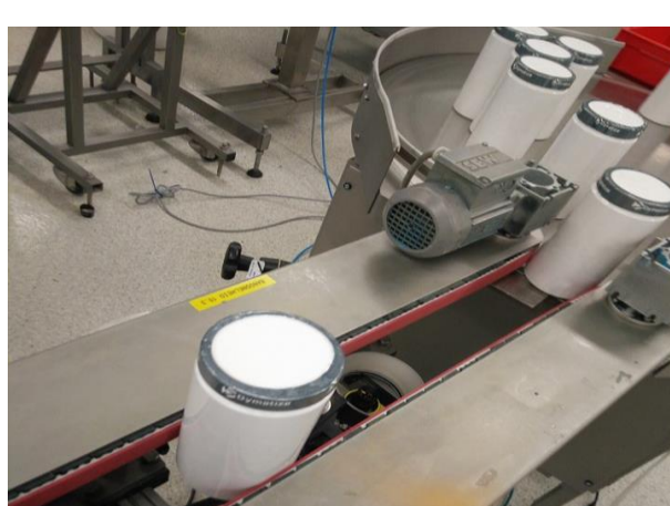
Figuur 72: Bovenaanzicht van Cognex In-sight 7600 color OCR-camera met koepel-verlichting tijdens testen op witte potjes met zwarte opdruk
