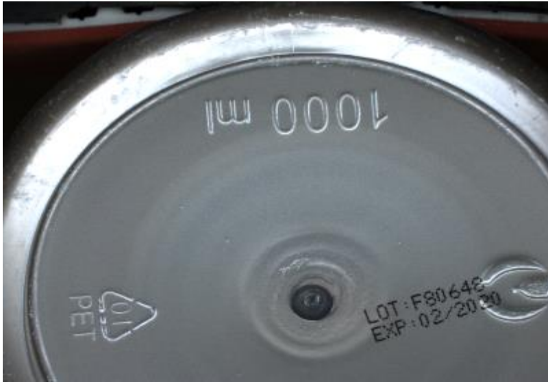
Figuur 71: Foto's van foutief uitgeworpen verpakkingen (grijze met zwarte codering) gemaakt door de In-Sight 7600
