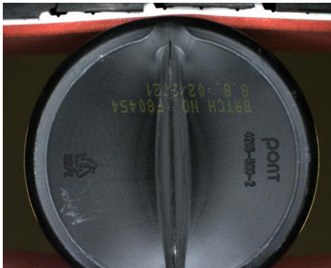
Figuur 16: Voorbeeld van een codering die niet gelezen kan worden door de aanwezigheid van reliëf (gemaakt door de In-Sight 7000 van Cognex)
