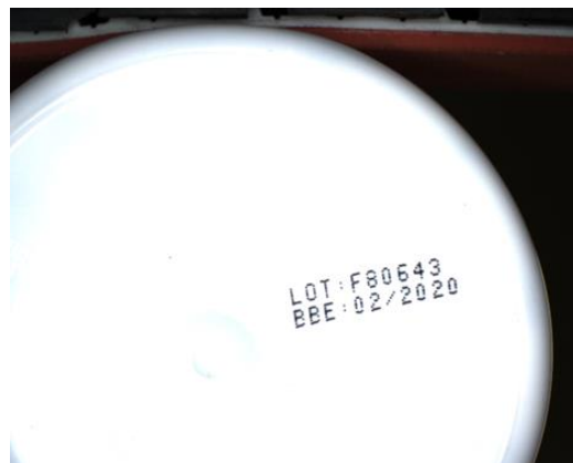
Figuur 20: Voorbeeld van een inkjetprint te Aminolabs genomen door de In-Sight 7000 camera van Cognex
