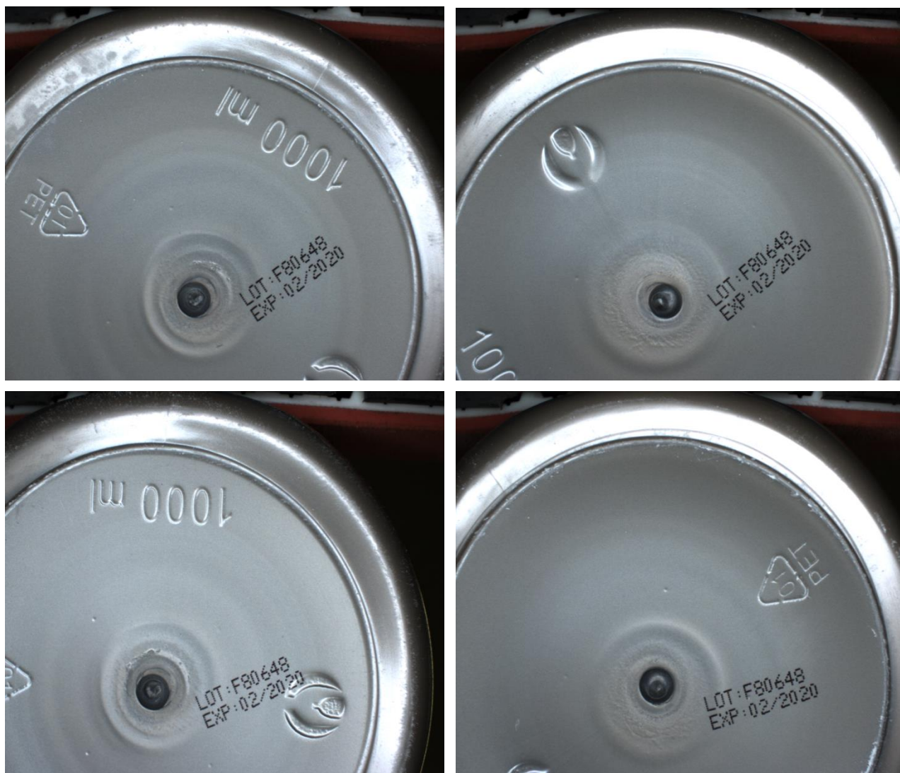
Figuur 70: Foto's van goed gelezen verpakkingen (grijze met zwarte codering) gemaakt door de In-Sight 7600
