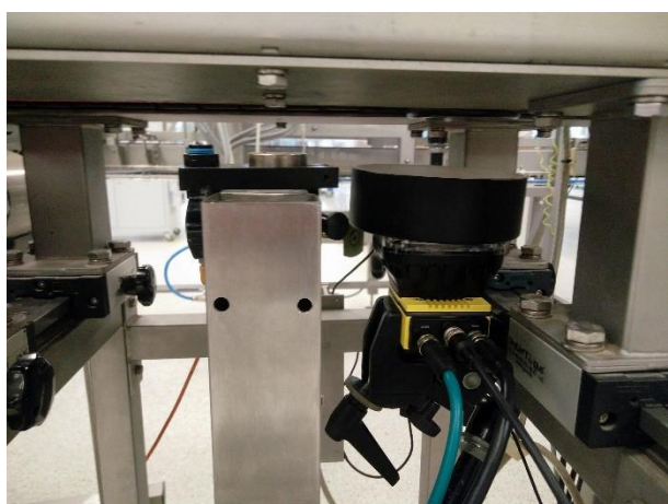
Figuur 65: Zijaanzicht van Cognex In-sight 7600 color OCR-camera met koepel-verlichting
