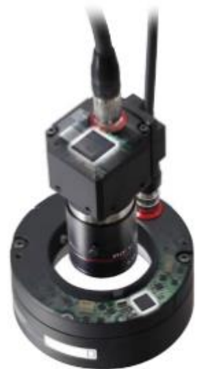
Figuur 43: LumiTraxTM (Integratie van camera belichting en inspectie algoritme) [48]
