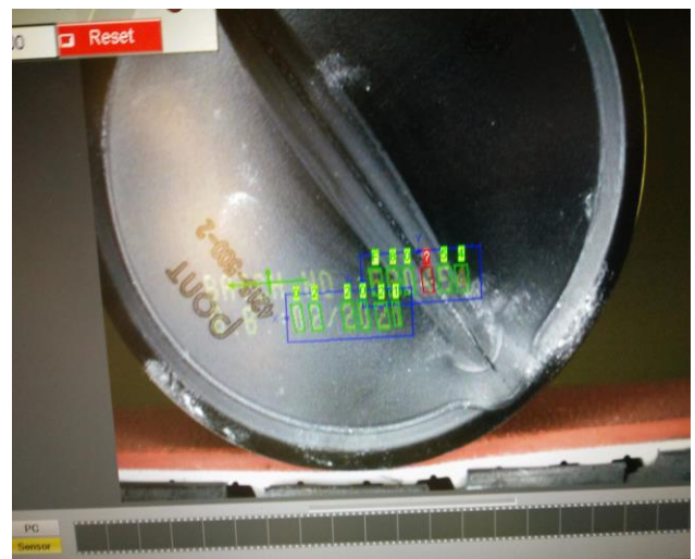
Figuur 55: Beeld van een afgekeurde codering
