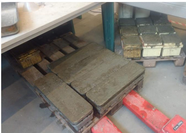
Figuur 51: Gevulde mallen prisma's en kubussen (0.07% nanovezelbeton)
