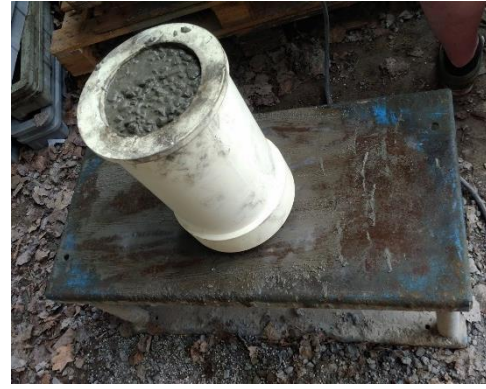
Figuur 54: Triltafel in werking
