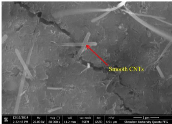
Figuur 17: Gladde nanobuizen zonder Sol Gel [15, p. 6]
