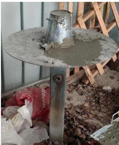
Figuur 55: Opstelling schudmaatproef referentiebeton
