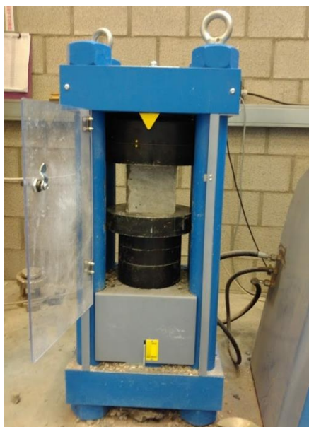
Figuur 71: Beginopstelling drukproef
