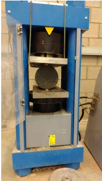
Figuur 75: Beginopstelling splijttreksterkteproef
