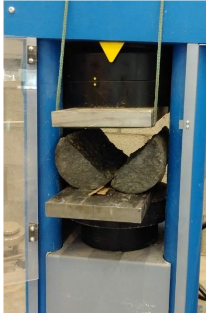
Figuur 76: Einde splijttreksterkteproef
