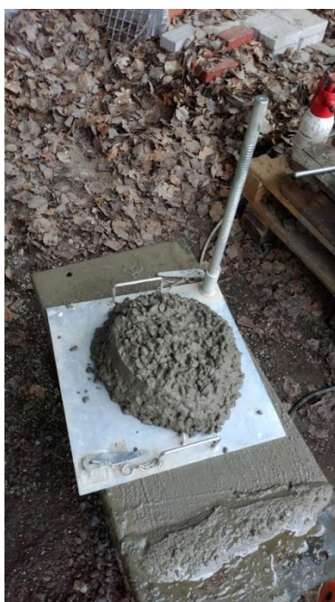
Figuur 62: Resultaat zetmaatproef met referentiebeton
