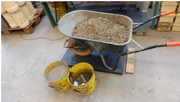
Figuur 47: Hoeveelheden 1 portie referentiebeton
