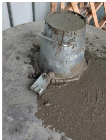
Figuur 56: Schudmaatkegel gevuld met referentiebeton
