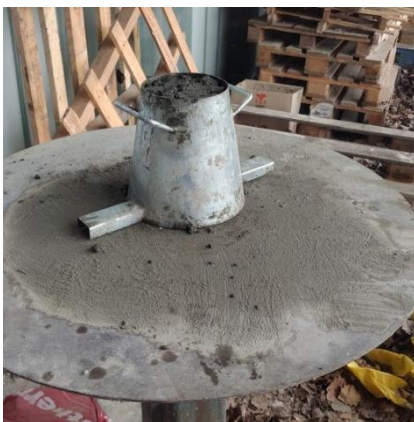
Figuur 58: Schudmaatkegel gevuld met 0.10% nanovezelbeton
