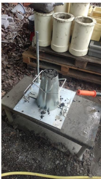
Figuur 61: Proefopstelling kegel van Abraham
