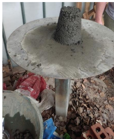
Figuur 59: 0.10% nanovezelkegel voor het uitvoeren van de schudmaatproef
