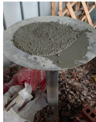
Figuur 57: Resultaat schudmaatproef referentiebeton
