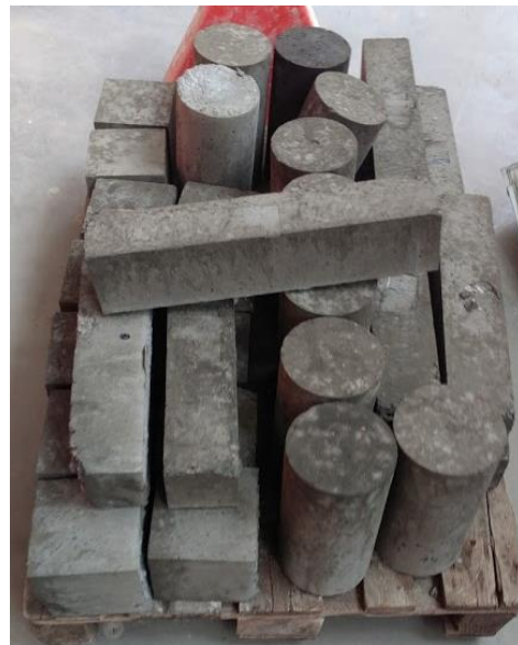
Figuur 66: Proefstukken 0.10% nanovezelbeton na ontkisten
