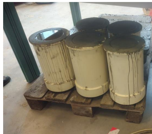
Figuur 52: Gevulde mallen cilinders (0.07% nanovezelbeton)
