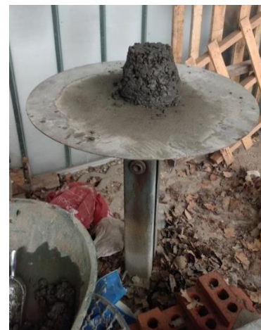
Figuur 60: 0.10% nanovezelkegel na het uitvoeren van de schudmaatproef
