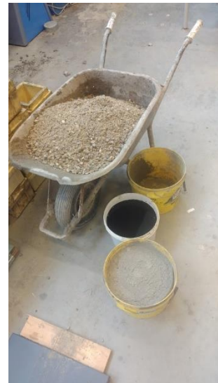
Figuur 48: Hoeveelheden 1 portie 0.10% nanovezelbeton
