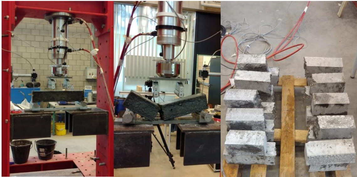
Figuur 79: Beginopstelling 4-puntsbuigproef
