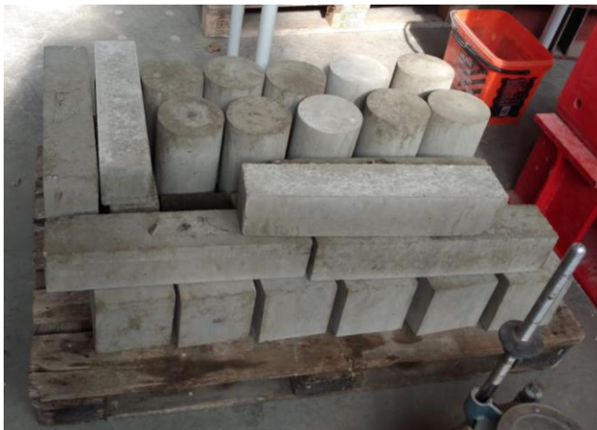
Figuur 65: Proefstukken referentiebeton na ontkisten
