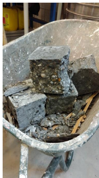
Figuur 73: Kubussen na het testen
