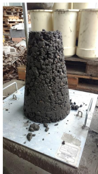
Figuur 63: Resultaat zetmaatproef met 0.10% nanovezelbeton
