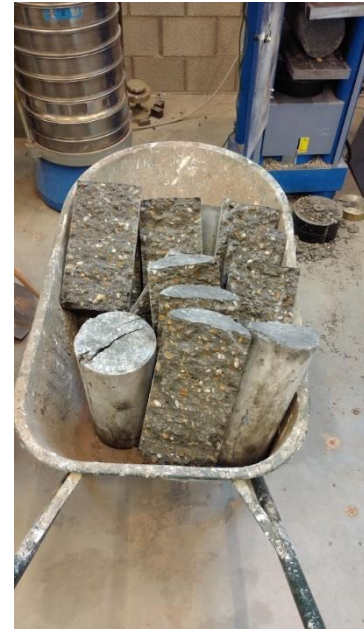
Figuur 77: Cilinders na het testen
