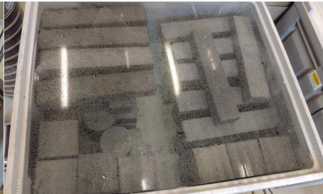
Figuur 68: Proefstukken in de waterbak (rechts referentiebeton, links 0.10% nanovezelbeton)
