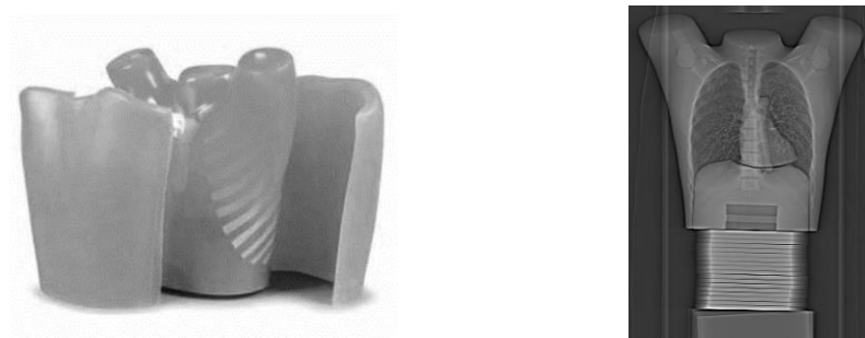
Figuur 7: Het Lungman fantoom met additionele borstplaten (links), topogram van het Lungman fantoom verlengd m.b.v. PMMA (rechts) [23]
