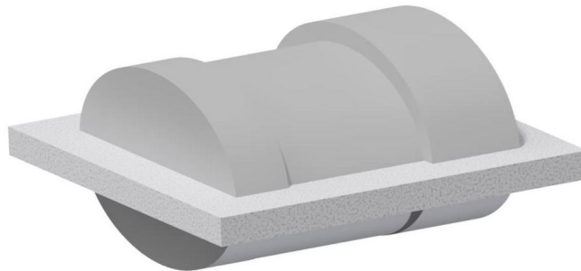
Figuur 10: Nabootsing van een patiënt (thorax en abdomen) met elliptische PMMA schijven samengehouden door piepschuim
