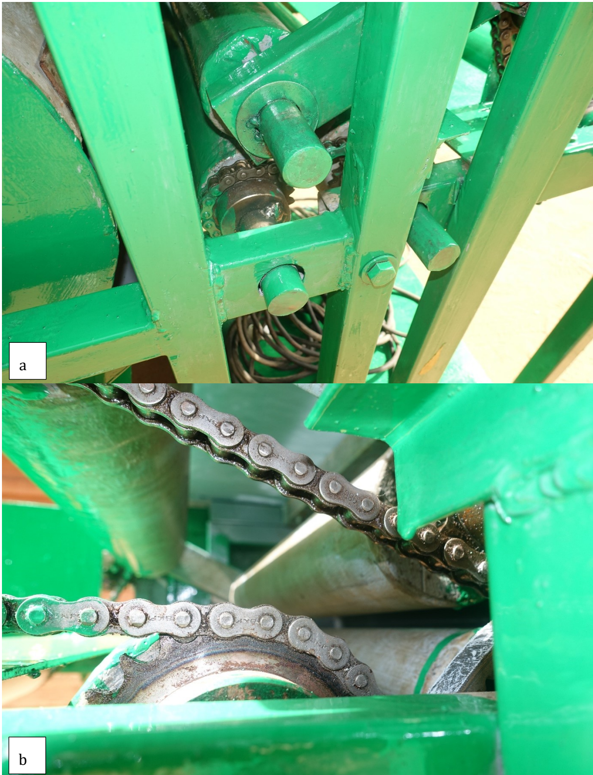
Figuur 48: Detailfoto overbrengingen rollen links (a) en detailfoto overbrengingen rollen rechts (b)
