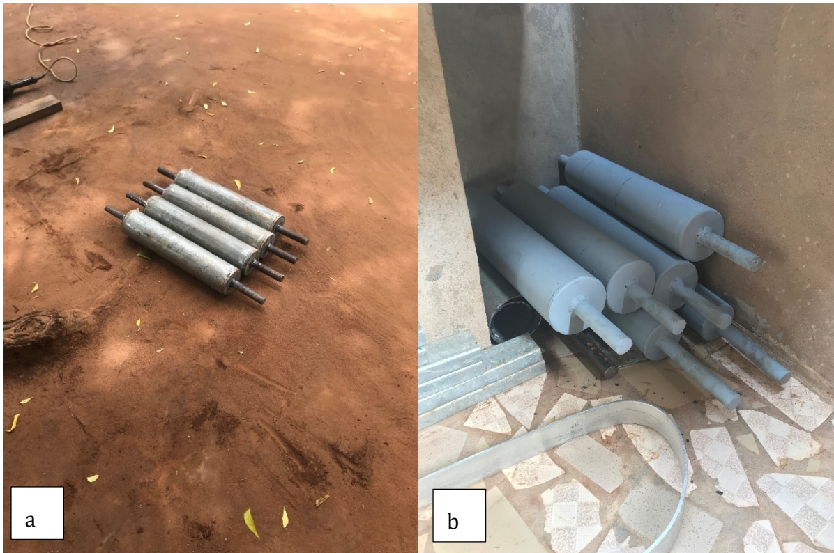
Figuur 30: Invoerrollen geassembleerd (a) en rollen klaar en geverfd (b)
