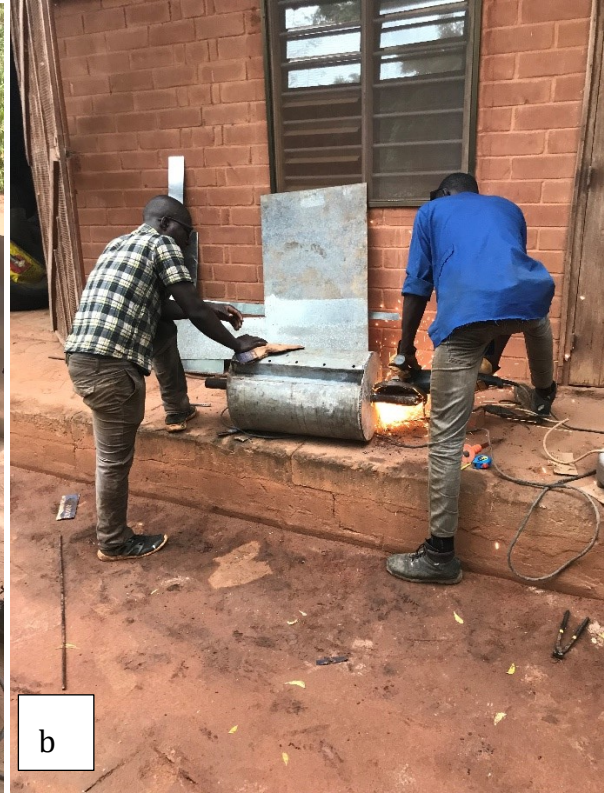
Figuur 37: Gatens boren in trommel voor bevestiging messen (a) en afwerking as trommel (b)
