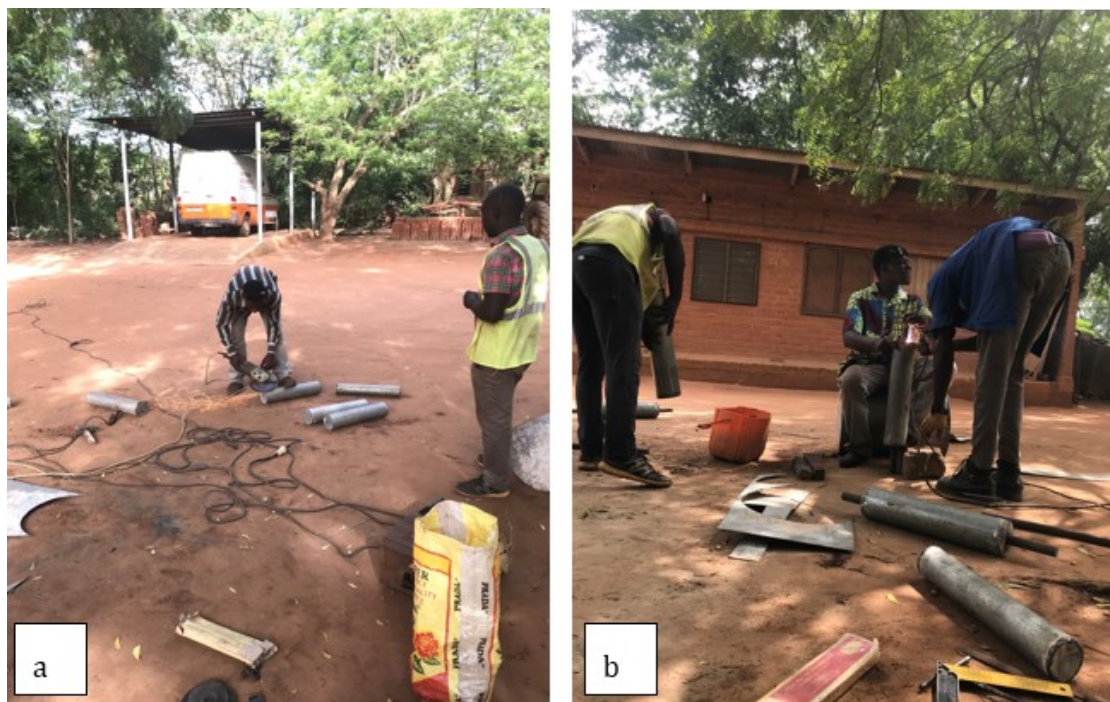
Figuur 29: Afwerking rollen (a) en assen in rollen bevestigen (b)
