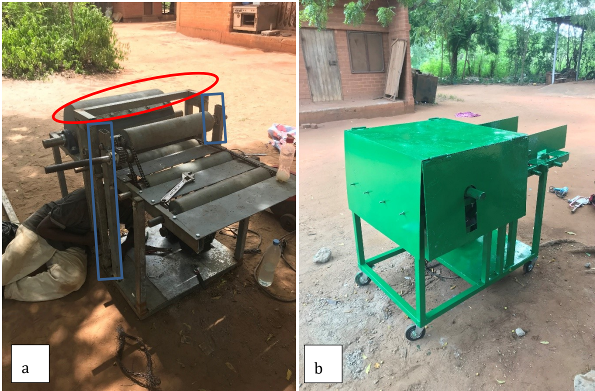
Figuur 43: Aanpassingen frame tijdens montage (a) en frame na montage (b)
