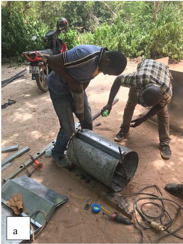
Figuur 37: Gatens boren in trommel voor bevestiging messen (a) en afwerking as trommel (b)
