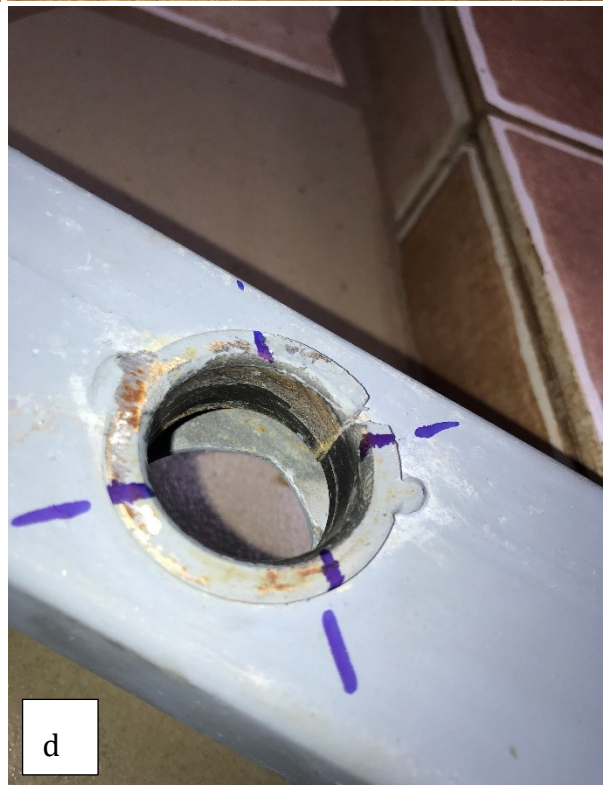
Figuur 32: Platen en frames verven (a), binnenkant glijlager met verf (b), glijlager proper gemaakt (c), binnenkant glijlager te hard aangetast (d)
