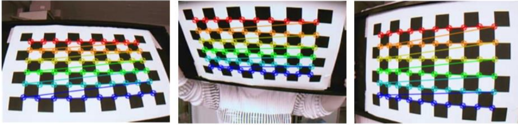
Figuur 33: Camerakalibratie met behulp van het schaakbordpatroon met hoekpuntdetectie [30, p. 19]
