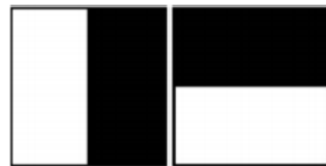
Figuur 29: Haar-wavelet gebruik in SURF [25, p. 6]
