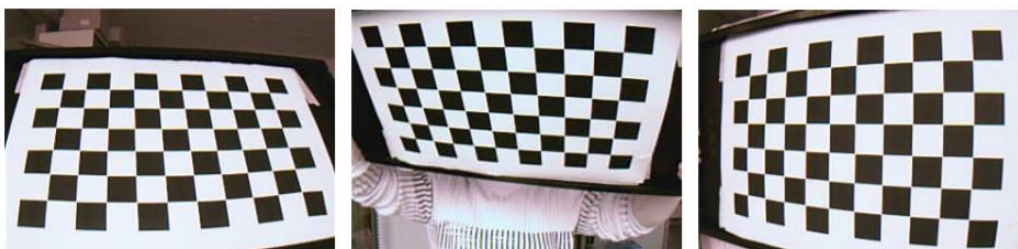
Figuur 32: Camerakalibratie met behulp van het schaakbordpatroon [30, p. 18]
