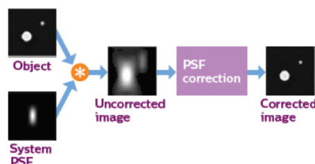
Figuur 11: Corrigeren van de systeemresolutie a.d.h.v. het PSF-algoritme [13, p. 10]
