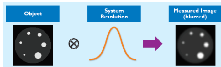
Figuur 10: Schematische voorstelling van vervaagen van PET-beelden door de systeemresolutie [18, p. 1]
