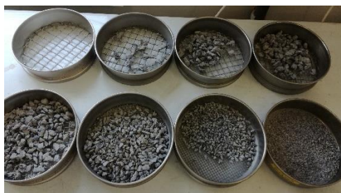
Figuur 22: Zeefmethode toegepast op het gerecycleerd betongranulaat groter dan 3 mm.
