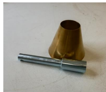
Figuur 25: Materialen gebruikt voor het drogen van het granulaat kleiner dan 4 mm tot SSD-conditie (a) Hete luchtblazer gebruikt voor het drogen; (b) Metalen kegel gebruikt voor bepaling van de SSD-conditie.
