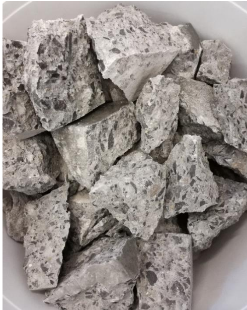
Figuur 13: Gebroken betonpuin met grootte kleiner dan 9 cm.
