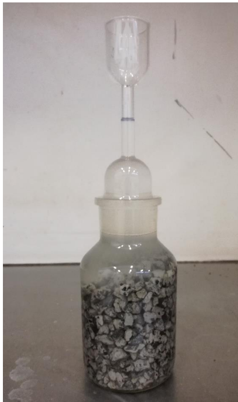
Figuur 23: Pyknometer gebruikt bij de bepaling van de waterabsorptie en de dichtheid (inhoud 1 l).
