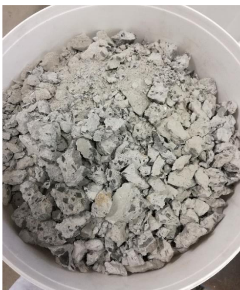
Figuur 15: Gerecycleerd betongranulaat na de eerste breekfase in de kaakbreker met opening 14 mm.
