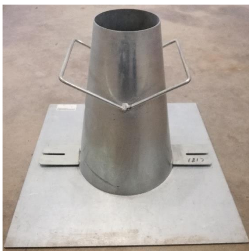
Figuur 10: De kegel van Abrams gebruikt voor de bepaling van de betonconsistentie.
