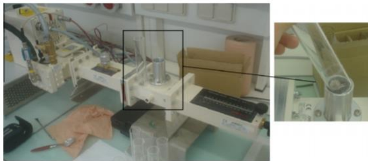
Figuur 5: Voorbeeld van een microgolf-testapparaat (SAIREM) [59].
