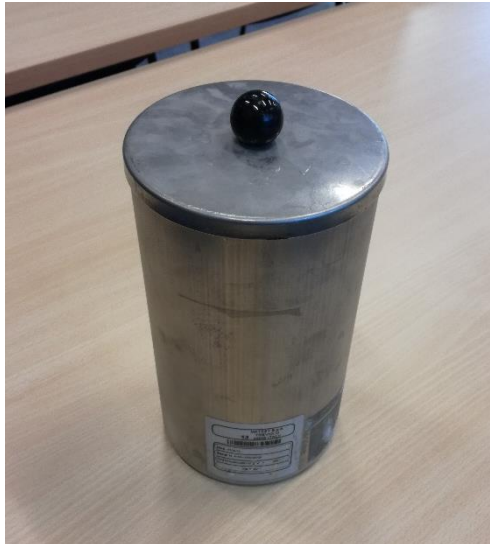
Figuur 28: Metalen container gebruikt voor de vorst-dooitest (inhoud 2 l).
