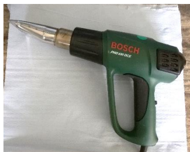
Figuur 25: Materialen gebruikt voor het drogen van het granulaat kleiner dan 4 mm tot SSD-conditie (a) Hete luchtblazer gebruikt voor het drogen; (b) Metalen kegel gebruikt voor bepaling van de SSD-conditie.
