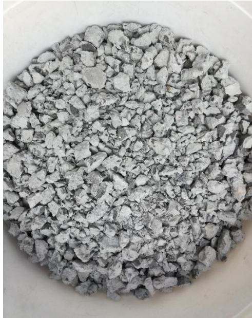
Figuur 16: Gerecycleerd betongranulaat na de tweede breekfase in de kaakbreker met opening 8,5 mm.
