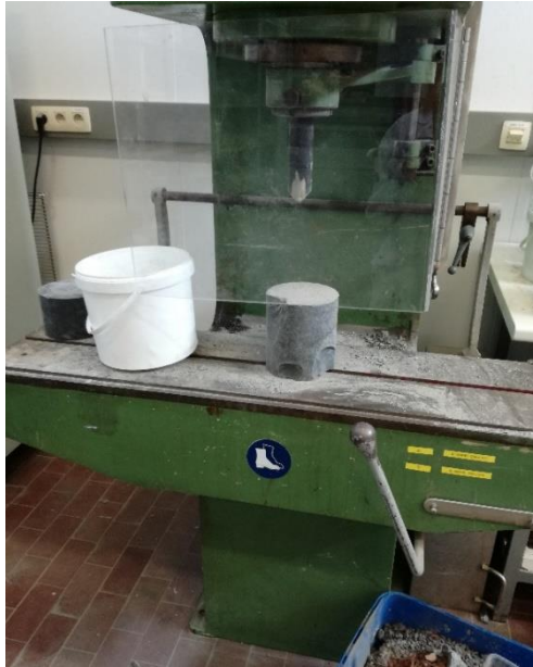
Figuur 12: Hydraulische puntpers gebruikt voor het breken van het beton tot stukken kleiner dan 9 cm.
