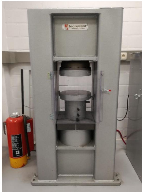
Figuur 11: Hydraulische drukbank gebruikt voor de bepaling van de betondruksterkte.
