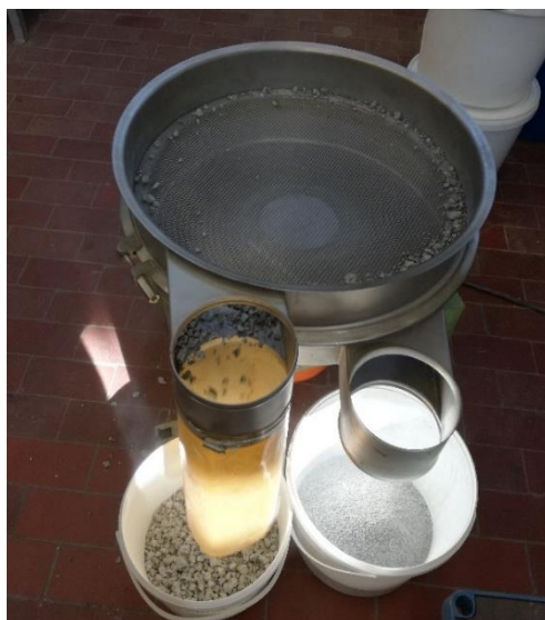
Figuur 17: Afzeving van het gerecycleerd betongranulaat op zeefmaat 3 mm.
