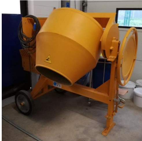
Figuur 18: Betonmixer voor het homogeniseren van het gerecycleerd betongranulaat groter dan 3 mm.
