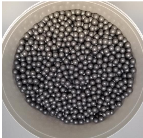
Figuur 27: Stalen ballen met diameter 10 \pm 0,5 mm gebruikt voor de micro-Deval test.
