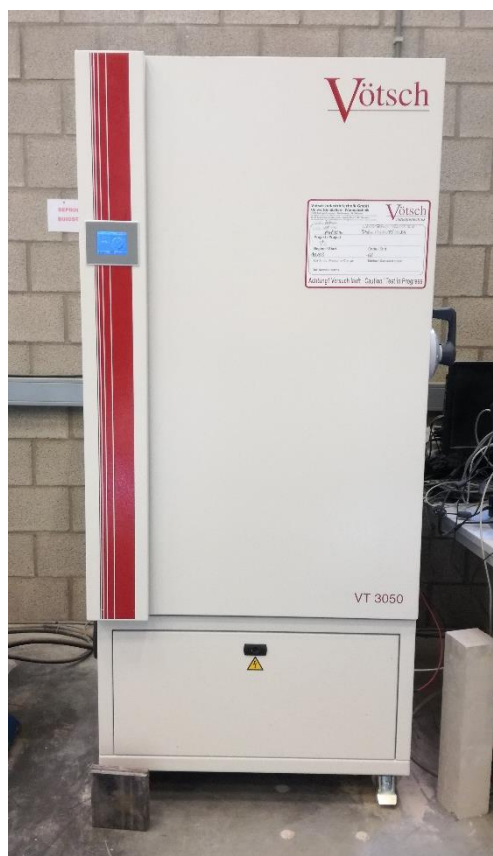
Figuur 29: Vorst-dooikast gebruikt voor de bepaling van de weerstand tegen vorst-dooicycli van granulaatfractie 8 mm tot 16 mm.
