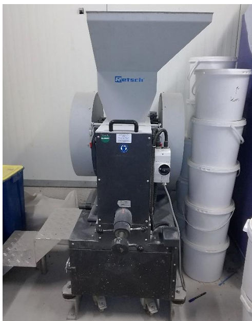
Figuur 14: Industriële kaakbreker gebruikt voor het breken van het beton tot gerecycleerd betongranulaat.
