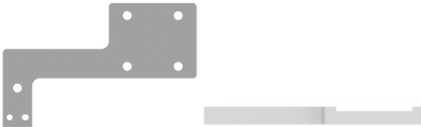
Figuur 19: Maakdeel verbinding rek met lineaire geleider (Zij- en bovenaanzicht)
