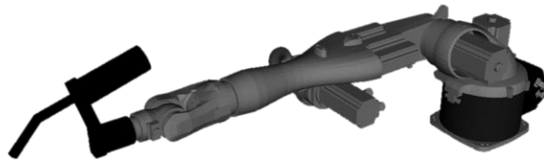
Figuur 15: KUKA KR5-robot met laspistool.
