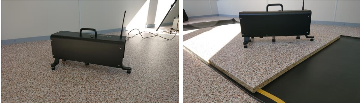
Figuur 4: Meting zonder (afbeelding links) en met zwevende dekvloer (afbeelding rechts)
