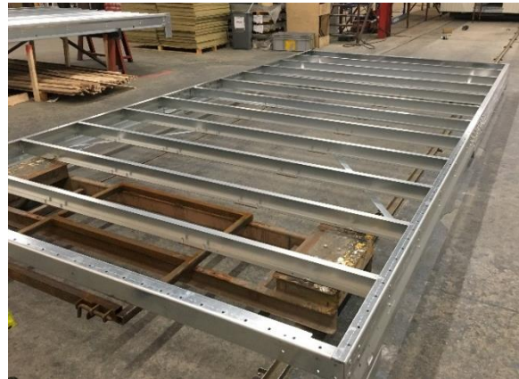
Figuur 15: Stalen draagconstructie voor de vloer
