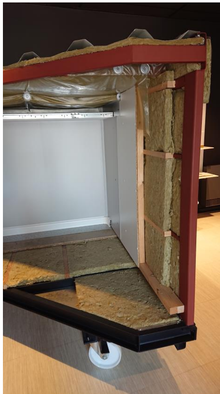
Figuur 5: Standaardopbouw (vloer – wand – plafond) – plafond is niet verlaagd in testopstelling
