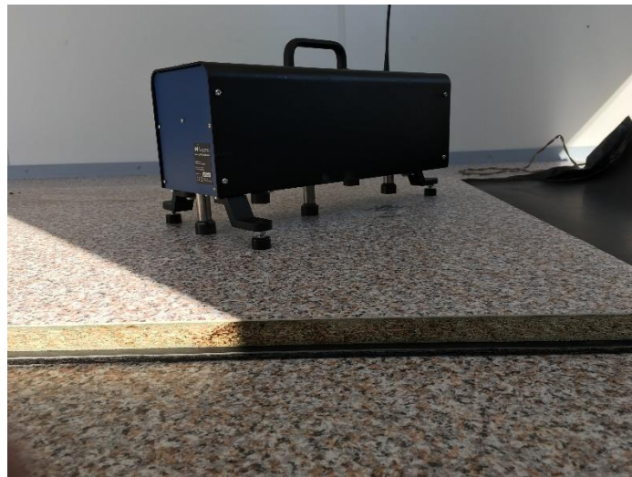
Figuur 30: Opstelling klopmachine bovenop zwevende dekvloer
