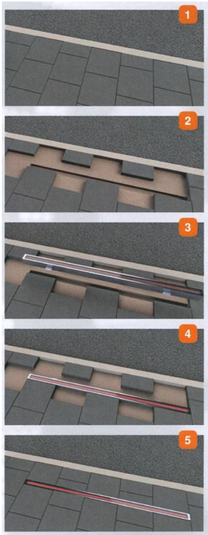
Figuur 18: Installatie +Lichtlijn (HIG Dynamische in Techniek, 2017)
