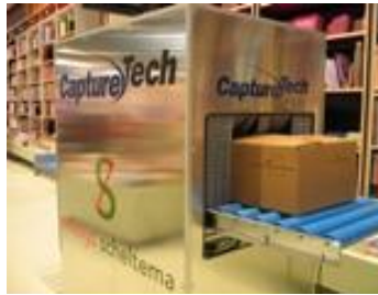
Figuur 4: RFID-tunnel (BGN, 2006)
