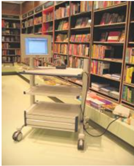
Figuur 20: het RFID-karretje voor inventarisatie (BGN, 2006)
