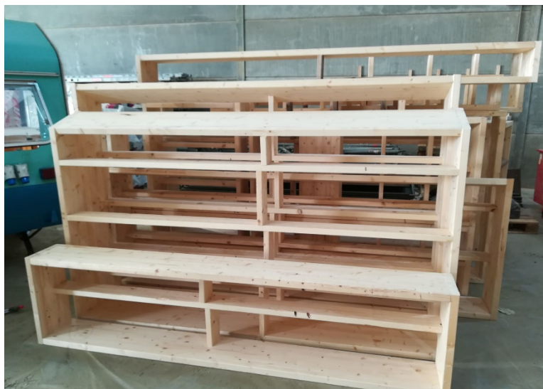
Figuur 5-5: Frames na montage balken (eigen foto)
