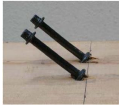
Figuur 2: Klassieke schroefverbinding tussen hout en beton [7, p. 16]
