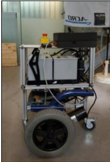
Figuur 1.1: (links) Mobiel platform gemaakt uit een rolstoelchassis tijdens een voorgaande masterproef [3]. (rechts) Het elektrisch en mechanisch aangepast mobiel platform uitgebreid met de robotarm UR5 tot de mobiele manipulator AMBER (ACRO MoBiLe Platform Extended with Robotic arm)
