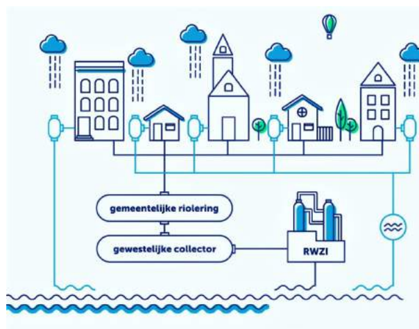
Figuur 1.1: De weg die het afval- en regenwater afleggen [3]
