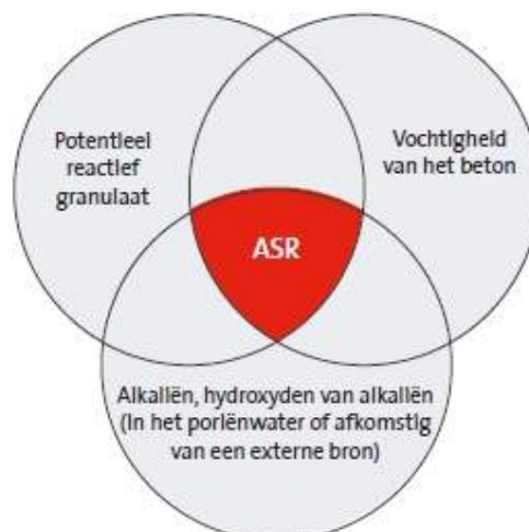
Figuur 3.1: Voorwaarden voor het optreden van ASR [15]
