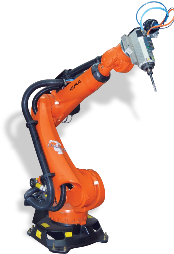
Figuur 1: KUKA robotarm met een freeskop als eideffector [3]
