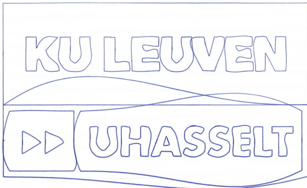
Figuur 52: KU Leuven en UHasselt logo, spline, gefilterd: DPT = 0,1 mm, hoektolerantie = 140°, oriëntatietolerantie = 140°
